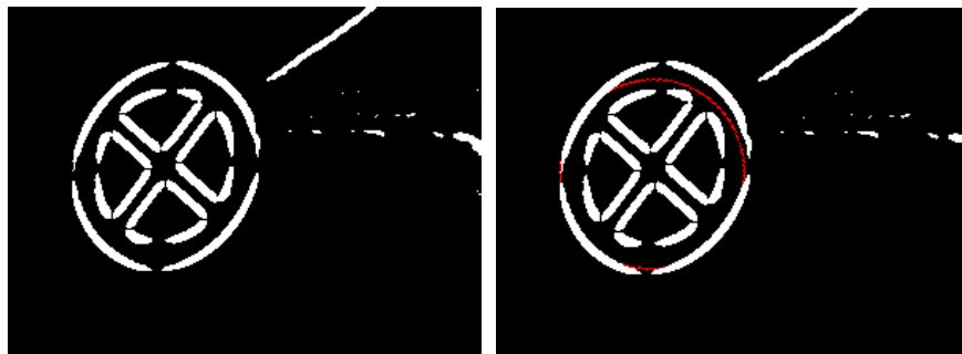
Obrázek 4-6: Genetický algoritmus pro detekci kruhu: a) originální snímek, b) segmentace červené barvy, c) po aplikaci kruhového filtru, d) detekovaná elipsa
