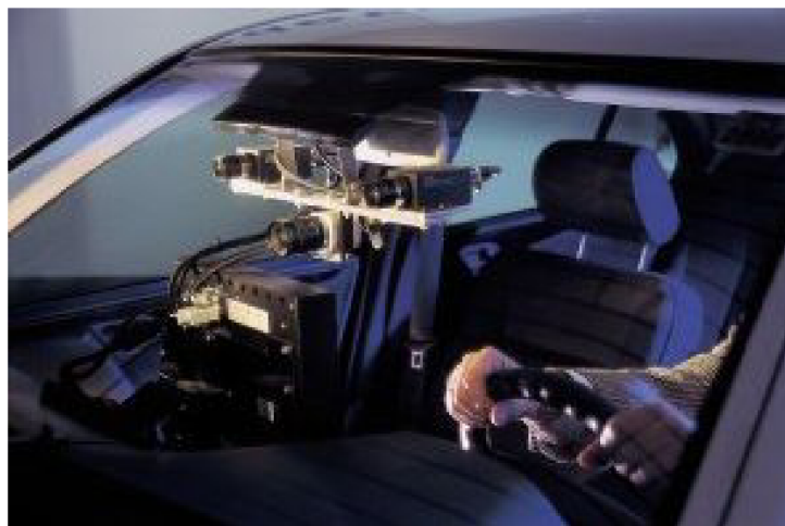
Obrázek 8-2: Koncept se třemi kamerami, Gavrilla [4]
