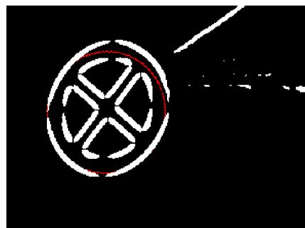
Obrázek 4-6: Genetický algoritmus pro detekci kruhu: a) originální snímek, b) segmentace červené barvy, c) po aplikaci kruhového filtru, d) detekovaná elipsa
