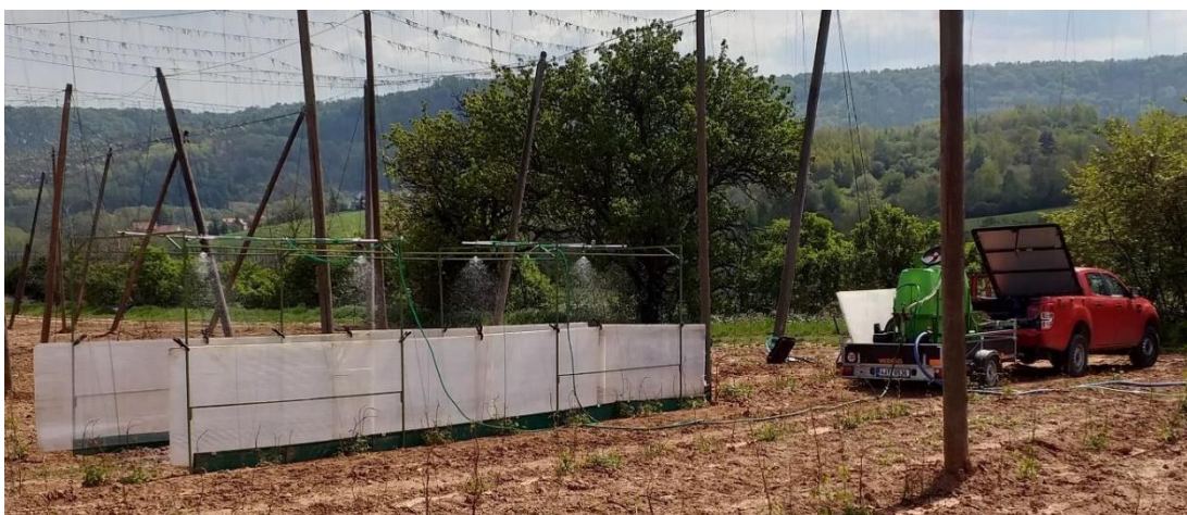
Obrázek č. 20: Simulátor deště (VÚMOP, 2019).
