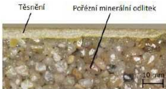
Obr. 7 Porézní minerální odlitek pro aktivní chlazení[8]
