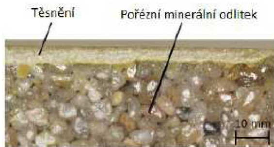
Obr. 7 Porézní minerální odlitek pro aktivní chlazení[8]
