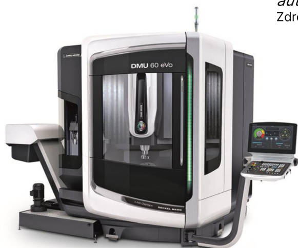
Obrázek 4: Pětiosé obráběcí centrum Zdroj: KNOMI, 2017
