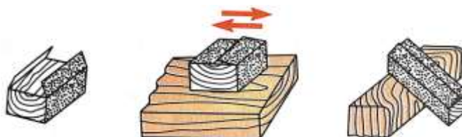
Obr. 39 – Broušení rovinných ploch a hran výrobku
