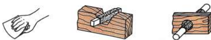
Obr. 38 – Broušení nepravidelných ploch výrobku
