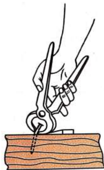
Obr. 57 – Vytahování špatně zatlučeného hřebíku
