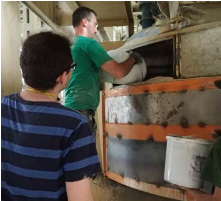
Obr. 26 : Dávkování jemně mleté teplárenské škváry do výrobní směsi cementotřískových desek
