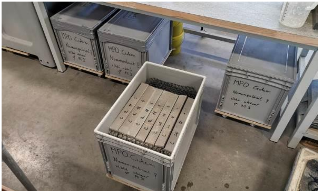
Obr. 33 : Uložení těles před testováním – prostředí o relativní vlhkosti 75 %
