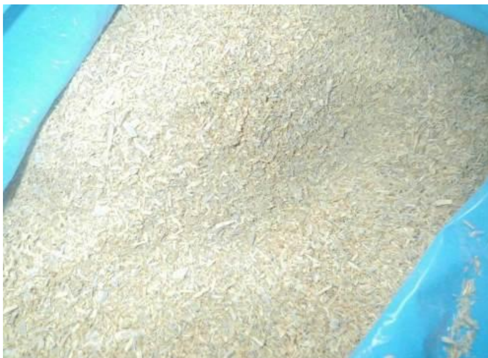
Obr. 24 : Druhotné třísky získané z drcení odřezků připravené před dávkováním do směsi pro výrobu cementotřískových desek
