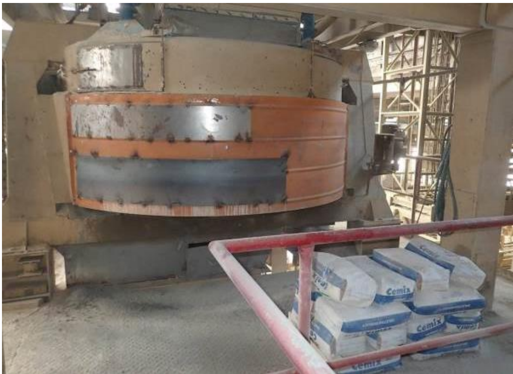
Obr. 21 : Mísící zařízení výrobní linky CIDEM Hranice, a.s. s připraveným jemně mletým vápencem
