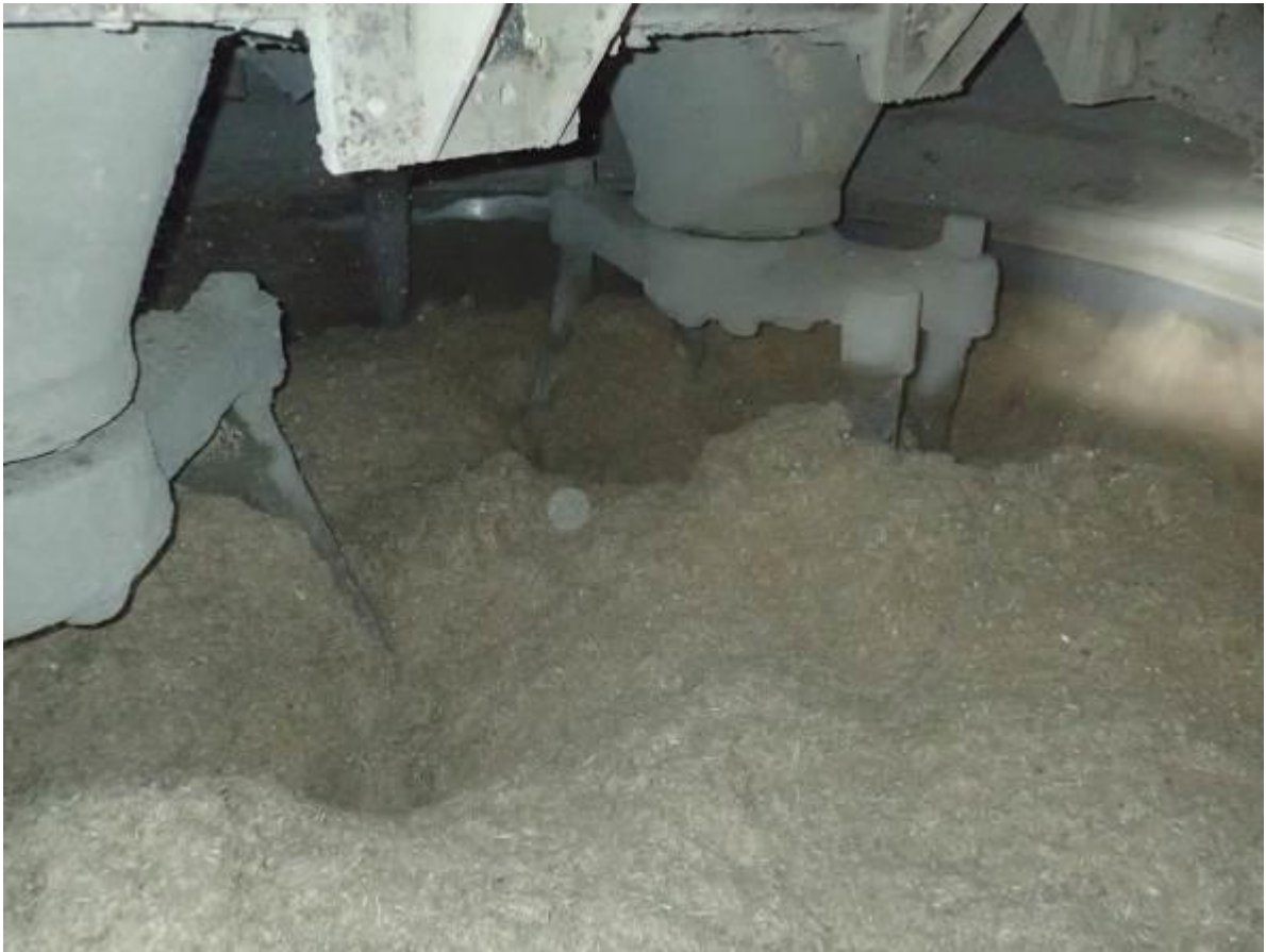
Obr. 28 Homogenizace třísek v mísicím zařízení pro výrobu desek
