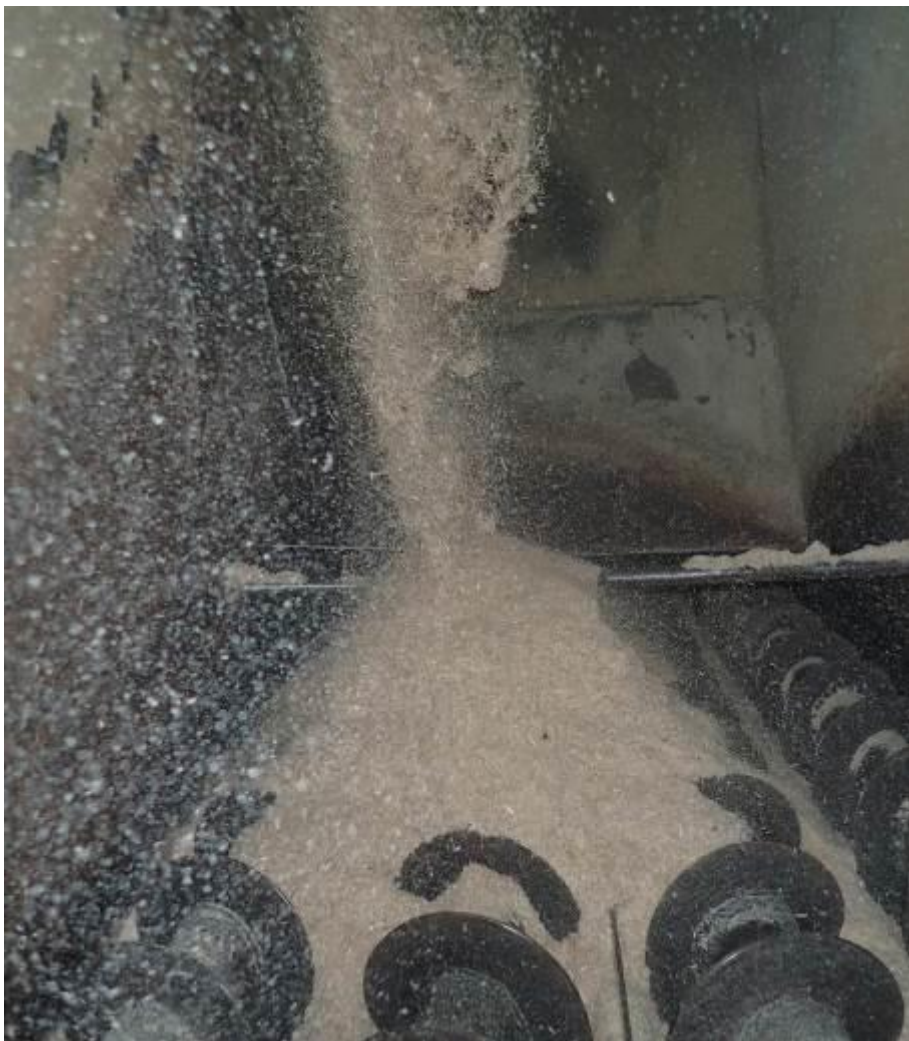
Obr. 23 : Dávkování primárních třísek do výrobní směsi cementotřískových desek
