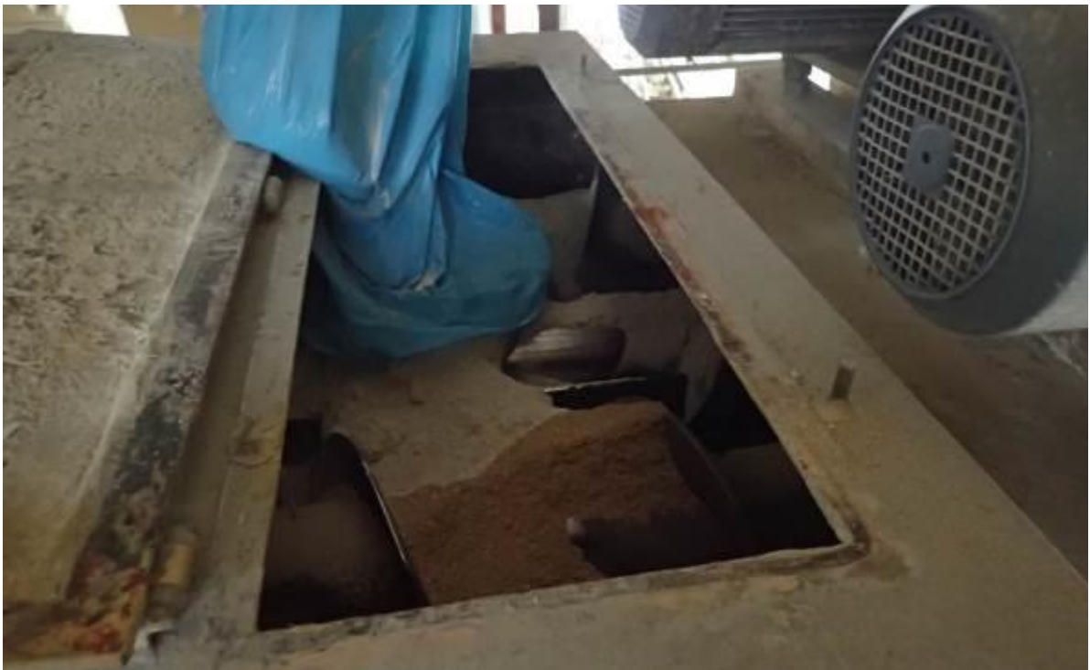
Obr. 27 : Dávkování prachu V2 do výrobní směsi cementotřískových desek
