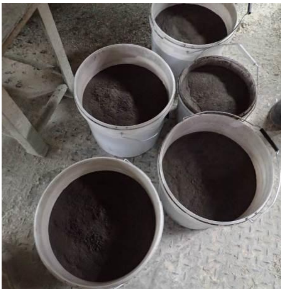
Obr. 25 : Jemně mletá teplárenská škvára připravená před dávkováním do směsi pro výrobu cementotřískových desek
