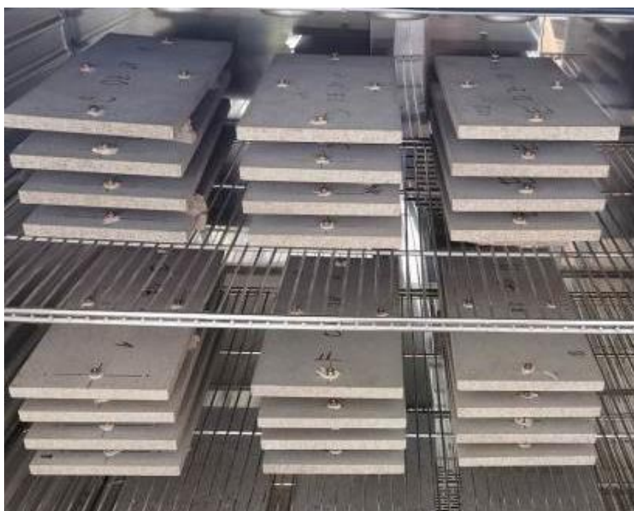
Obr. 35 : Zkušební tělesa cementotřířkových desek modifikovaného složení (matrice i plnivo) v sušárně – sušení do konstantní hmotnosti při 40 °C před testováním vlivu hygroskopicity v souvislosti s objemovými a hmotnostními změnami
