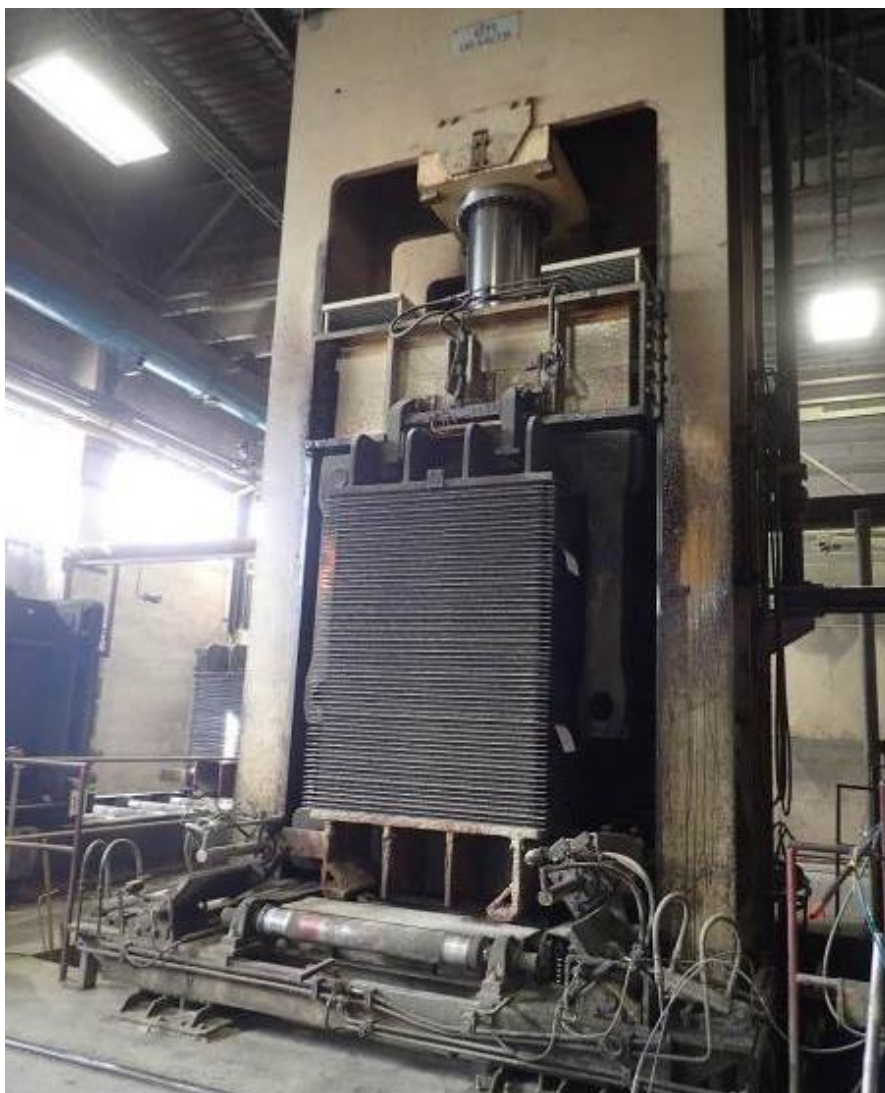
Obr. 31 : Navrstvené jednotlivé desky (modifikované receptury) v průběhu lisování
