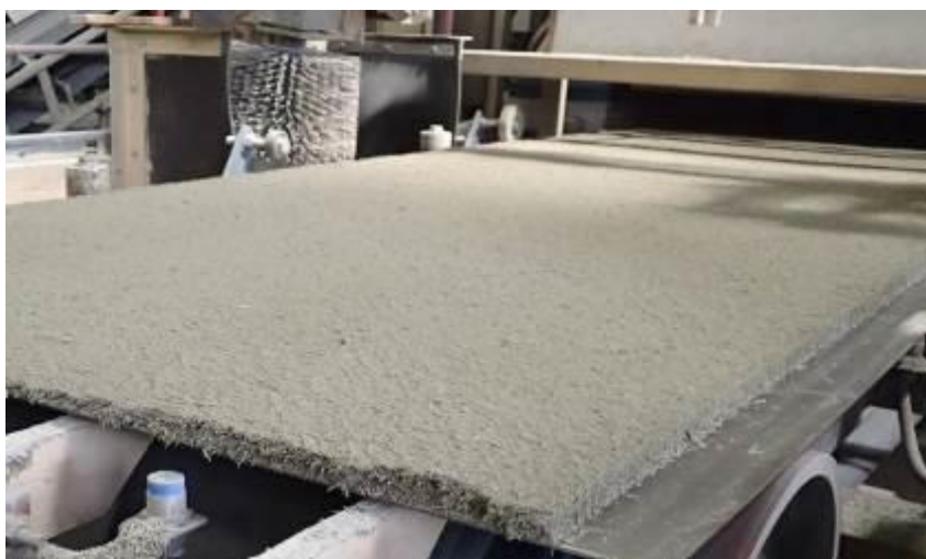
Obr. 30 : Detail na vrstvené směsi modifikované receptury cementotřískových desek
