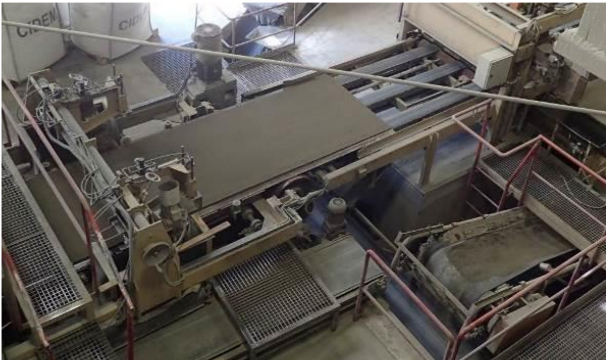
Obr. 29 : Čerstvá navrstvená směs na výrobní lince před lisováním a proteplováním
