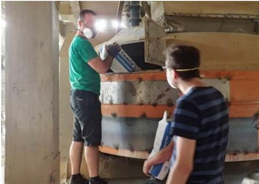
Obr. 22 : Dávkování jemně mletého vápence do výrobní směsi cementotřískových desek
