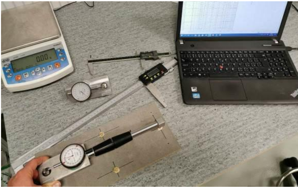
Obr. 36 : Deska modifikovaného složení (matrice) v průběhu analyzování objemových a hmotnostních změn vlivem rostoucí relativní vlhkosti okolí při teplotě cca 22 °C
