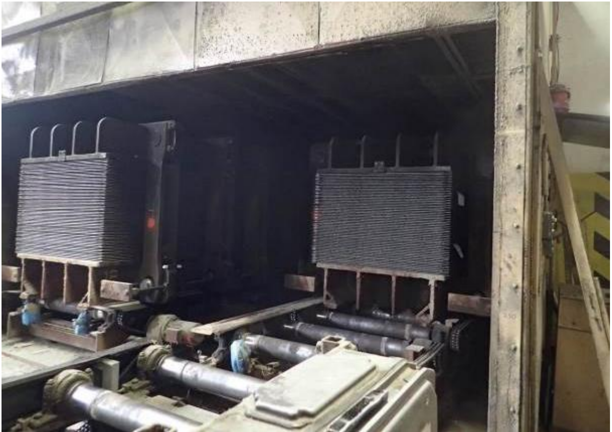
Obr. 32 : Slisované desky umístěné v propařovací komoře (před 1. fází proteplování)
