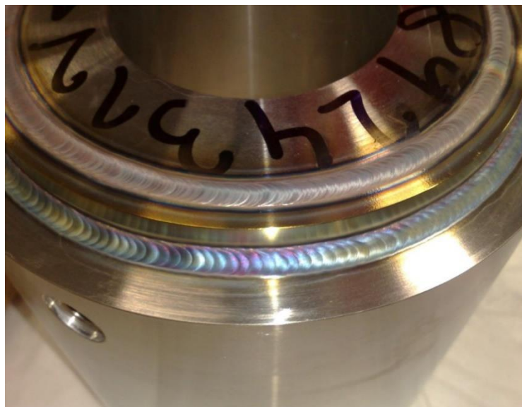
Obr. 19: Svar korozivzdorné oceli metodou TIG [35]
