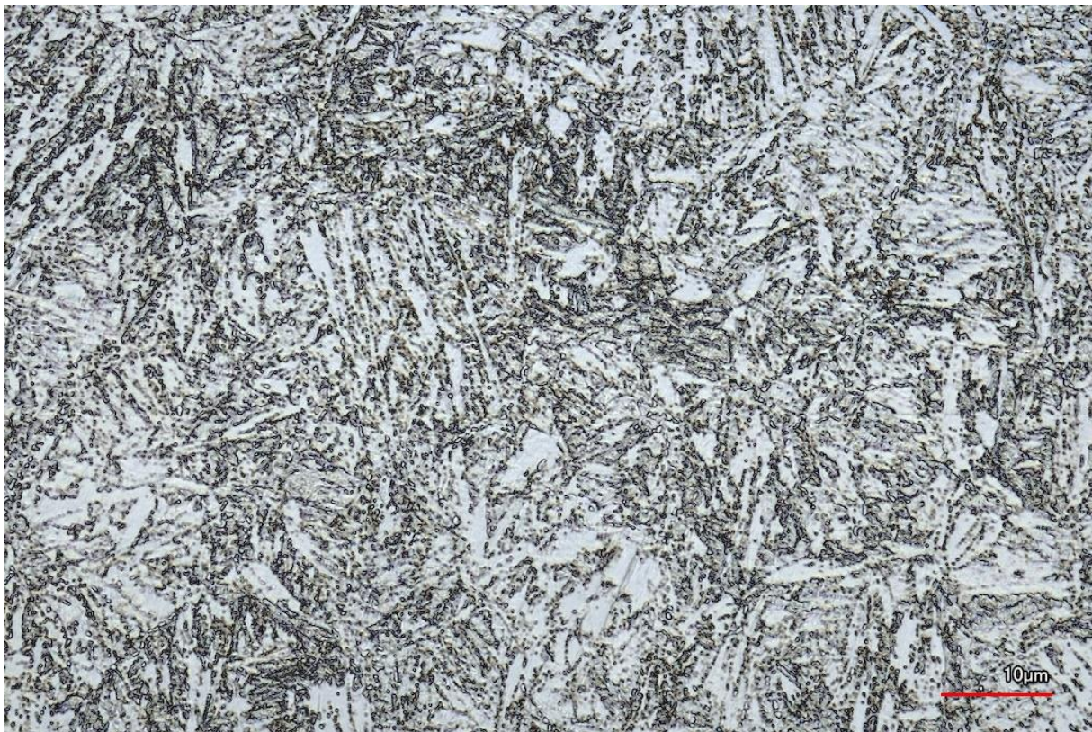
Obr. 64: Mikrostruktura základního materiálu X22CrMoV12-1
