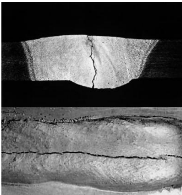
Obr. 26: Krystalizační trhliny (Al slitina) [55]
