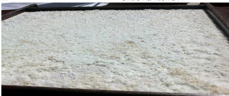
Obrázek č. 22: Vrstva vzniklého šlemu výšky několika milimetrů na vzorku A
