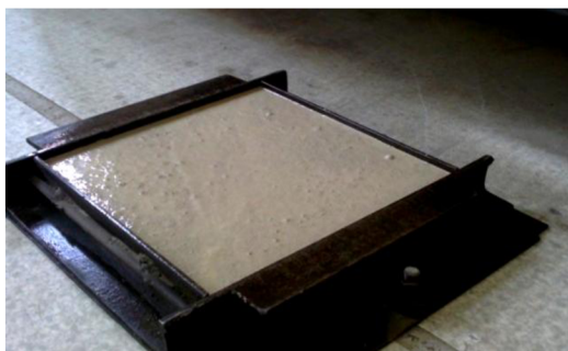
Obrázek č. 232: Čerstvá potěrová směs v ocelové formě
