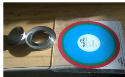
Obrázek č. 16: Haegermannův kužel a rozlivný terč
