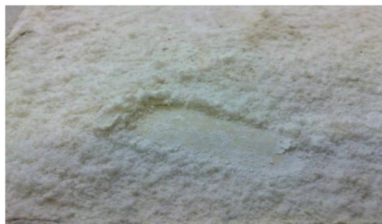
Obrázek č. 243: Detail vykrystalizované vrstvy sintru na vzorku A
