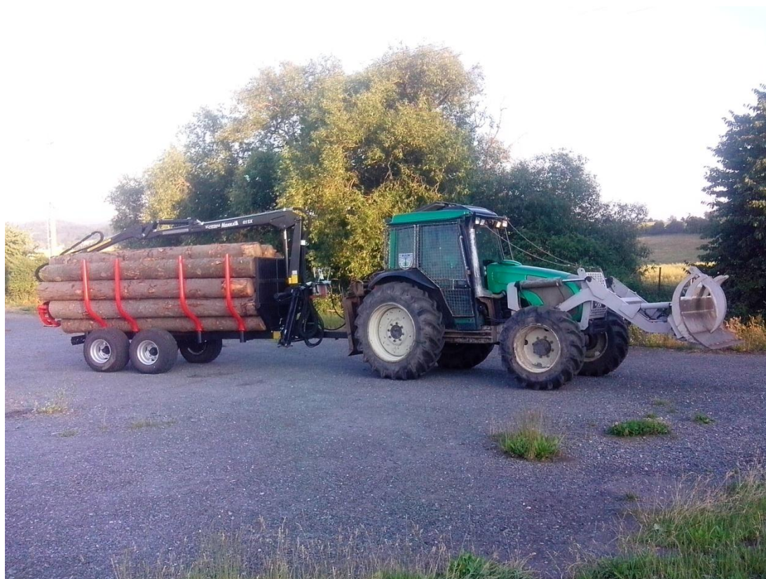
Obrázek č. 3 – Vyvážecí souprava UKT Valtra A85 a NOKKA 819 SX (Zdroj: vlastní)
