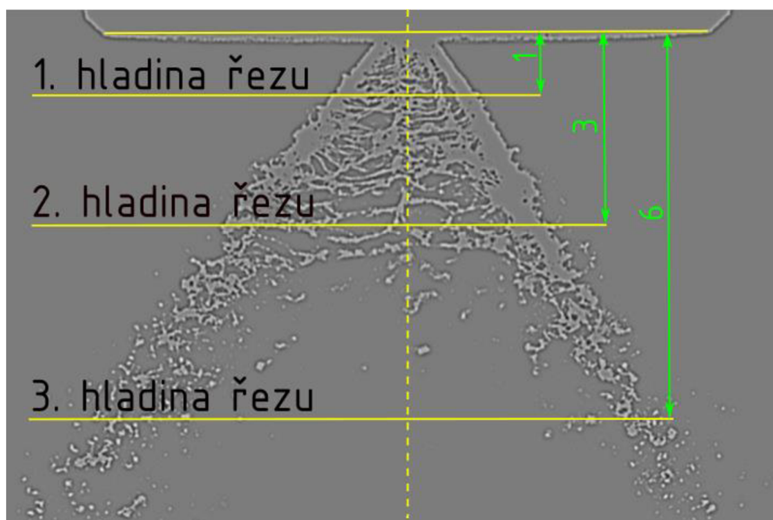
Obr. 8.2 - Schéma se vzdálenostmi jednotlivých hladin řezu kužele spreje
