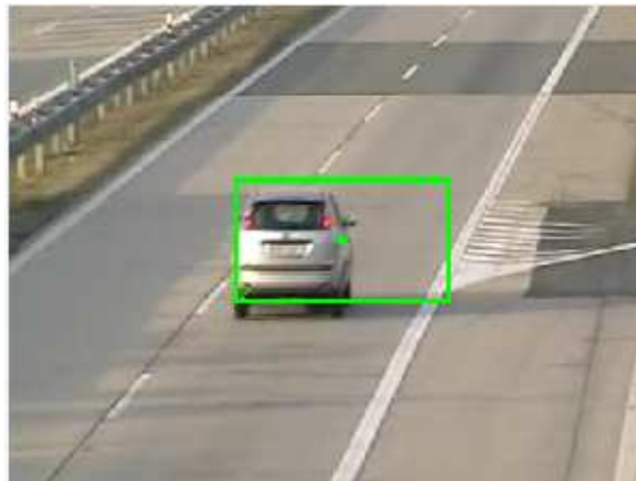
Obrázek 47: Vzdálenost objektů od sebe nastavena na 100 pixelů. Dochází k nevhodnému spojení objektů.
