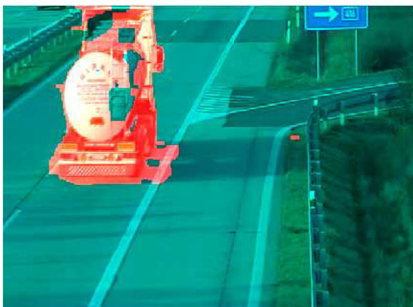
Obrázek 44: Odstraněny velké části objektu
