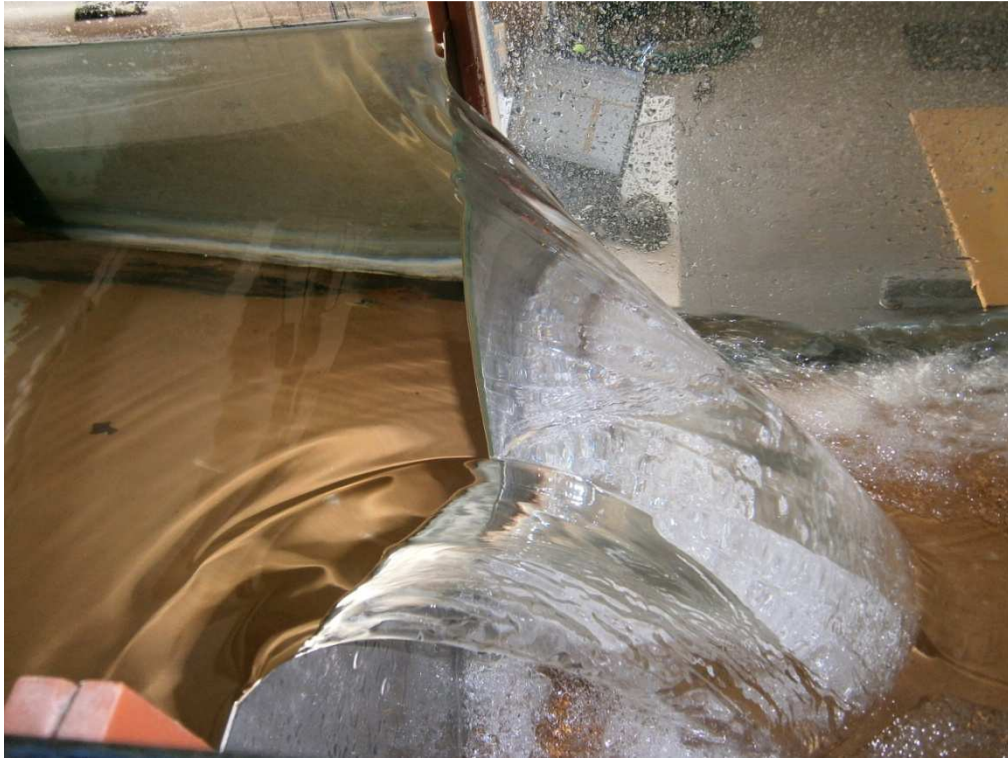
Fotografie formování přepadového paprsku trojúhelníkového ostrohranného přelivu s vrcholovým úhlem výřezu 90^\circ - průtok 15,8 \text{ l}\cdot\text{s}^{-1} (maximální průtok)
