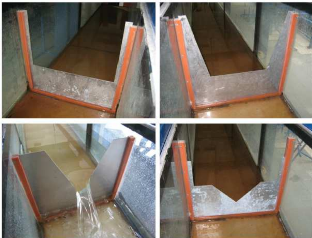
Obr. 2 Ostrohranné přelivy s pravoúhlým, lichoběžníkovým, trojúhelníkovým výřezem a s výřezem kombinovaným, fotodokumentace LVV
