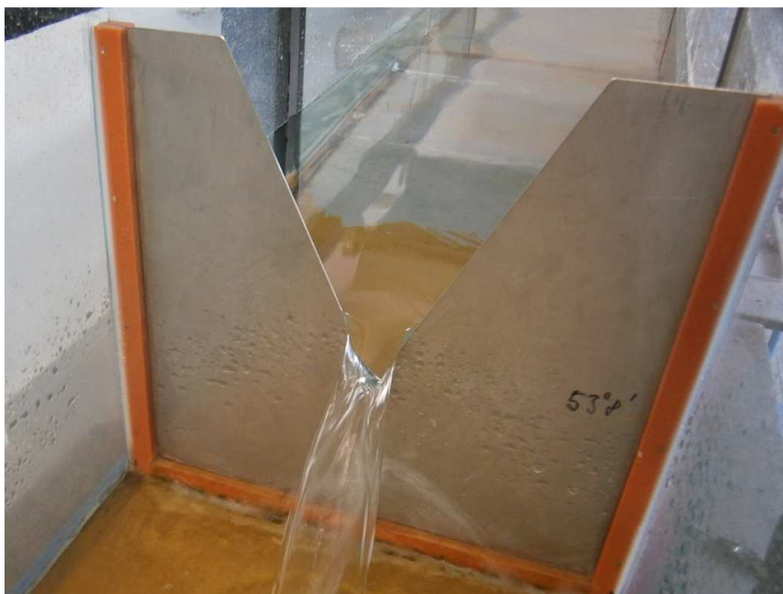
Obr. 23 Fotografie instalovaného trojúhelníkového ostrohranného přelivu s vrcholovým úhlem výřezu 53°8' - průtok 0,6 l·s -1
