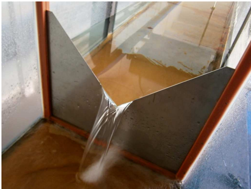
Obr. 22 Fotografie instalovaného trojúhelníkového ostrohřanného přelivu s vrcholovým úhlem výřezu 90^\circ - průtok 0,8 \text{ l}\cdot\text{s}^{-1}
