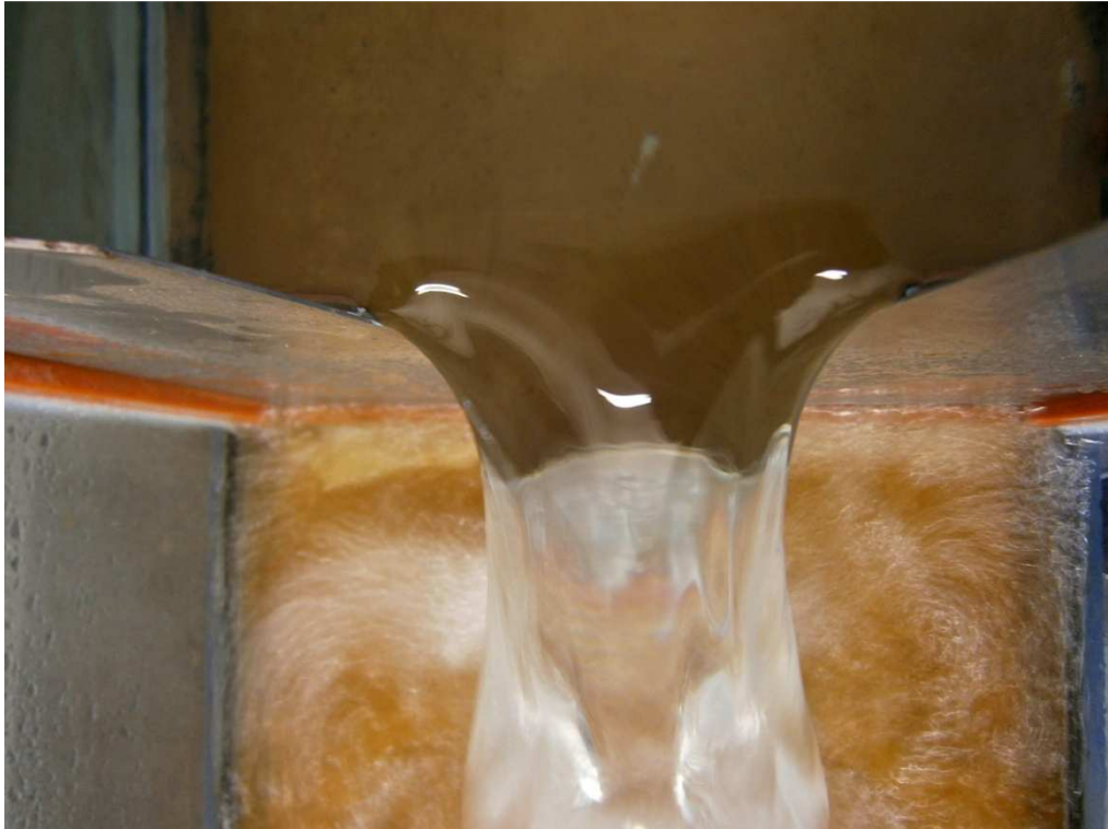
Fotografie půdorysného pohledu na přeliv s vrcholovým úhlem výřezu 28^{\circ}4' - průtok 5,1 \text{ l}\cdot\text{s}^{-1}
