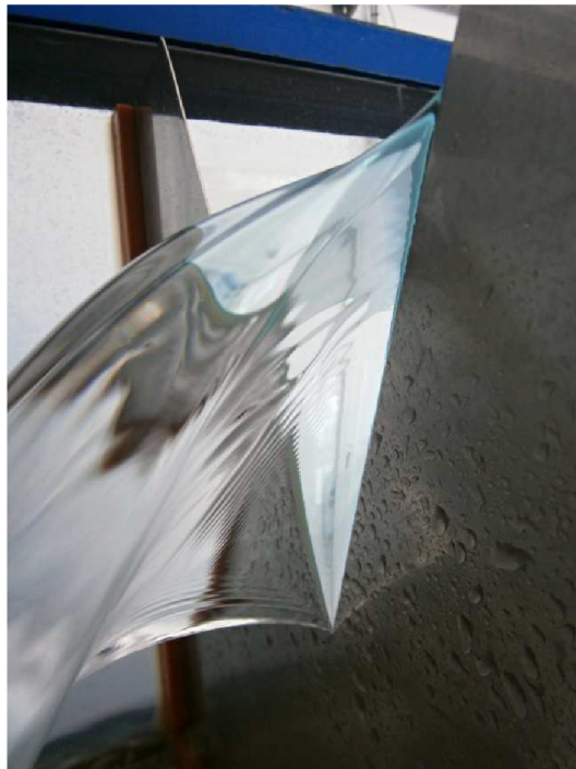
Fotografie přelivu s vrcholovým úhlem výřezu 53^{\circ}8' s formováním přepadového paprsku - průtok 4,7 \text{ l}\cdot\text{s}^{-1}
