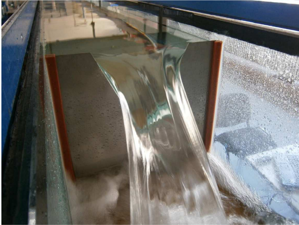
Fotografie instalovaného trojúhelníkového ostrohranného přelivu s vrcholovým úhlem výřezu 53^{\circ}8' - průtok 15,8 \text{ l}\cdot\text{s}^{-1} (maximální průtok)
