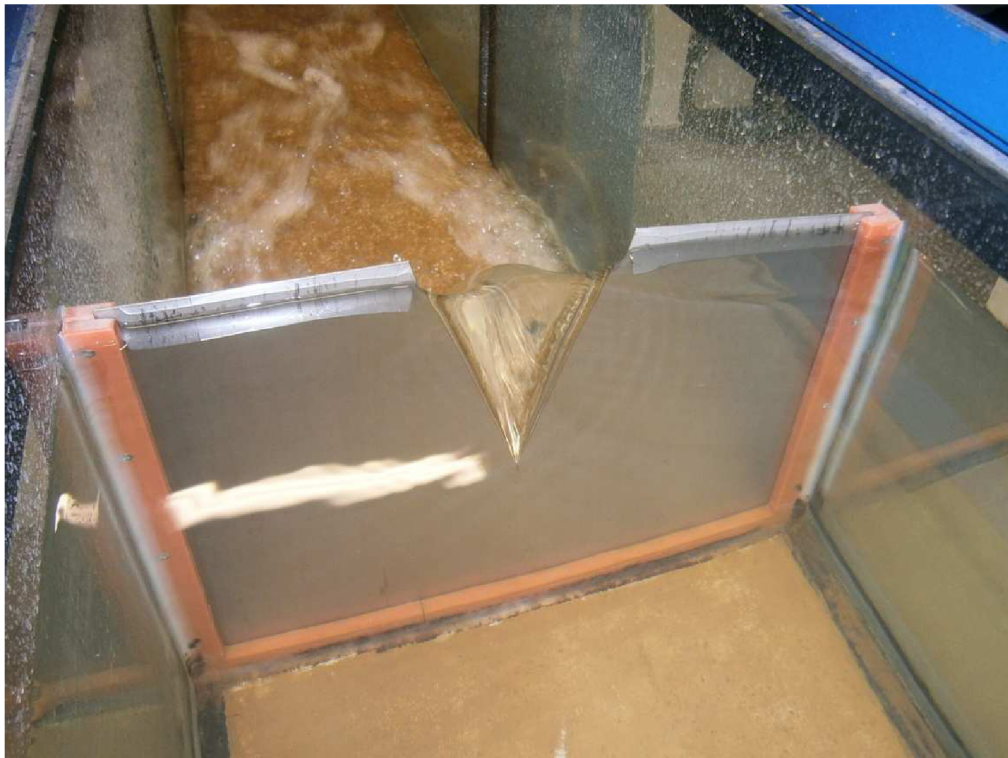
Fotografie instalovaného trojúhelníkového ostrohranného přelivu s vrcholovým úhlem výřezu 28^{\circ}4' - průtok 8,4 \text{ l}\cdot\text{s}^{-1} (maximální průtok)
