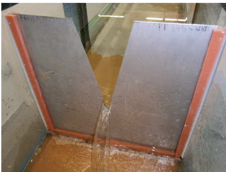
Obr. 24 Fotografie instalovaného trojúhelníkového ostrohranného přelivu s vrcholovým úhlem výřezu 28°4' - průtok 0,2 l·s -1
