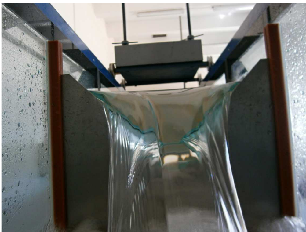
Fotografie instalovaného trojúhelníkového ostrohranného přelivu s vrcholovým úhlem výřezu 90^\circ - průtok 10,1 \text{ l}\cdot\text{s}^{-1}
