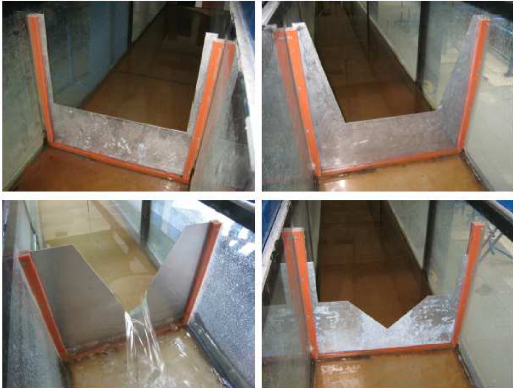
Obr. 2 Ostrohranné přelivy s pravoúhlým, lichoběžníkovým, trojúhelníkovým výřezem a s výřezem kombinovaným, fotodokumentace LVV
