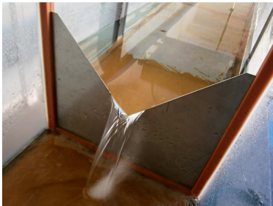
Obr. 22 Fotografie instalovaného trojúhelníkového ostrohranného přelivu s vrcholovým úhlem výřezu 90^\circ - průtok 0,8 \text{ l}\cdot\text{s}^{-1}
