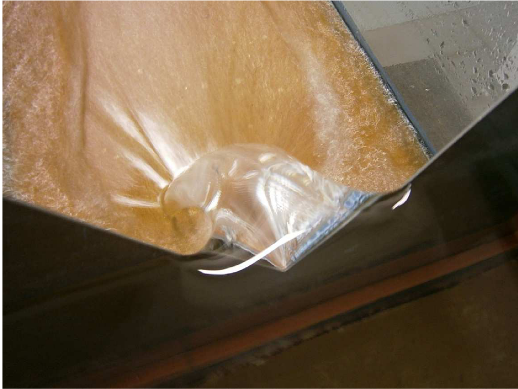
Fotografie s ukázkou formování přepadového paprsku na ostrohranném přelivu s vrcholovým úhlem výřezu 53^{\circ}8' - průtok 1,9 \text{ l}\cdot\text{s}^{-1}
