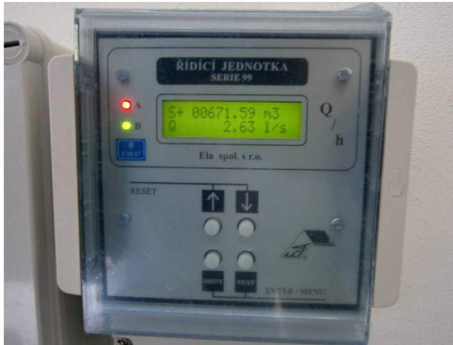
Obr. 21 Fotografie vyhodnocovací jednotky průtokoměru do 3 \text{ l}\cdot\text{s}^{-1}
