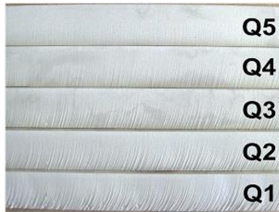
Obr. 5 Kvalita řezu (Q1-nejhorší, Q5-nejlepší) [25].
