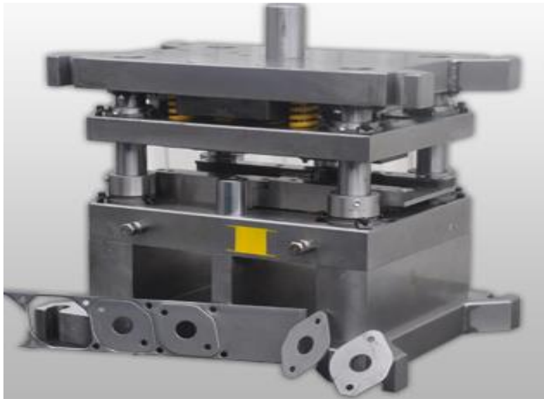
Obr. 6 Příklad postupového střížného nástroje [26].
