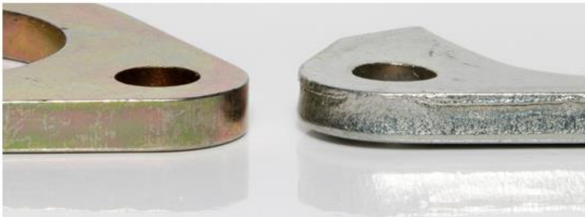
Obr. 8 Součást vystřížená přesným (vlevo) a běžným (vpravo) stříháním [28].
