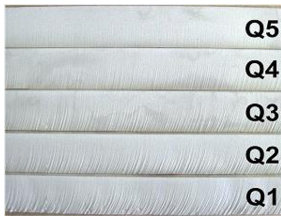
Obr. 5 Kvalita řezu (Q1-nejhorší, Q5-nejlepší) [25].
