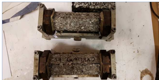
Obr. 38: Trámce na zkoušku nízkoteplotních vlastností
