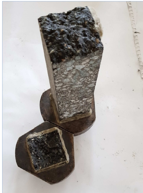
Obr. 27: Porušený vzorek ze zkoušky nízkoteplotních vlastností
