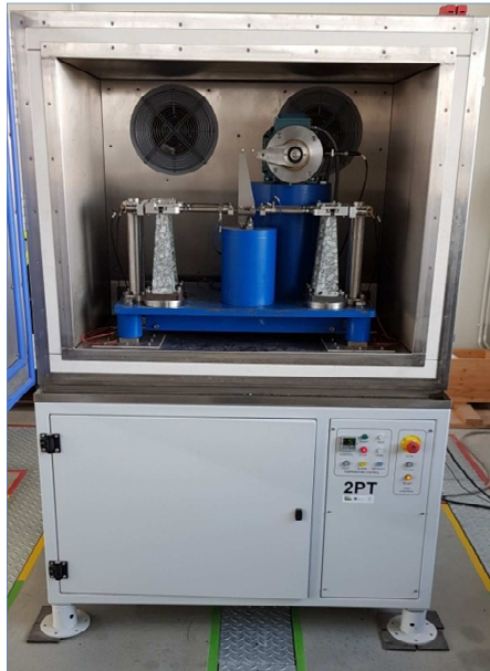
Obr. 24 a 25: Zkušební zařízení „Cooper“ pro zkoušku modulů tuhosti a únavy asfaltových směsí
