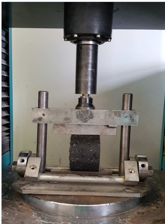
Obr. 22: Zkušební těleso v lisu při zkoušce ITSR
