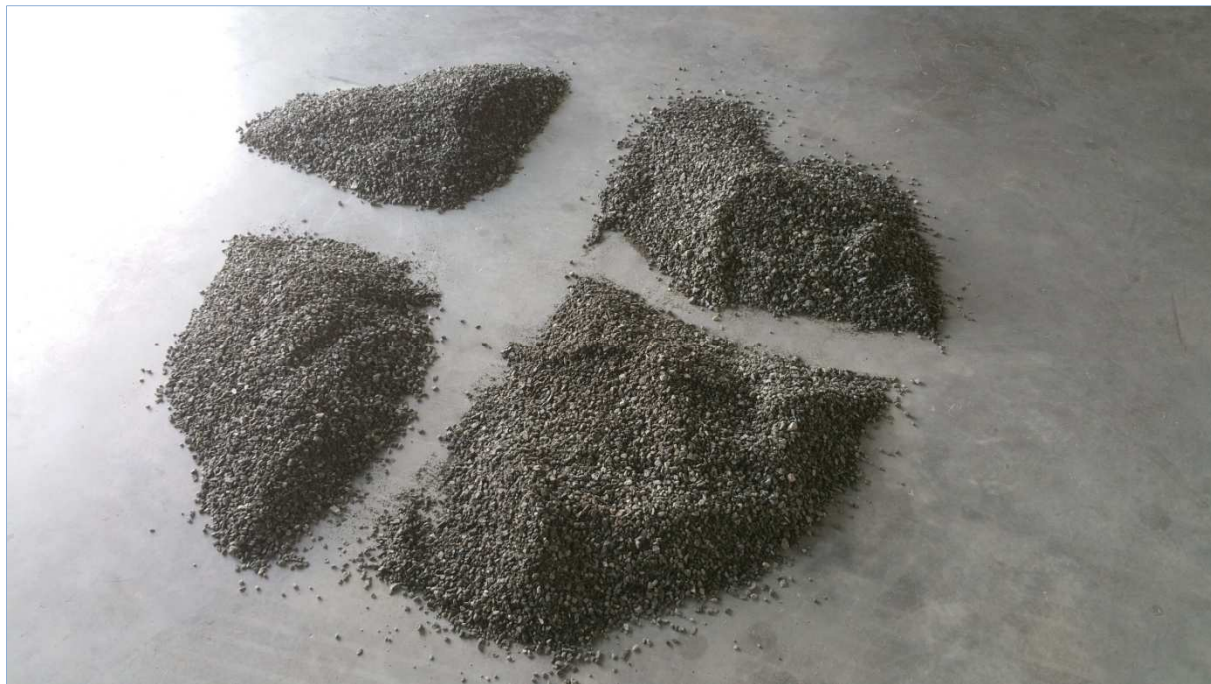
Obr. 16: Kvartace kameniva frakce 8/11
