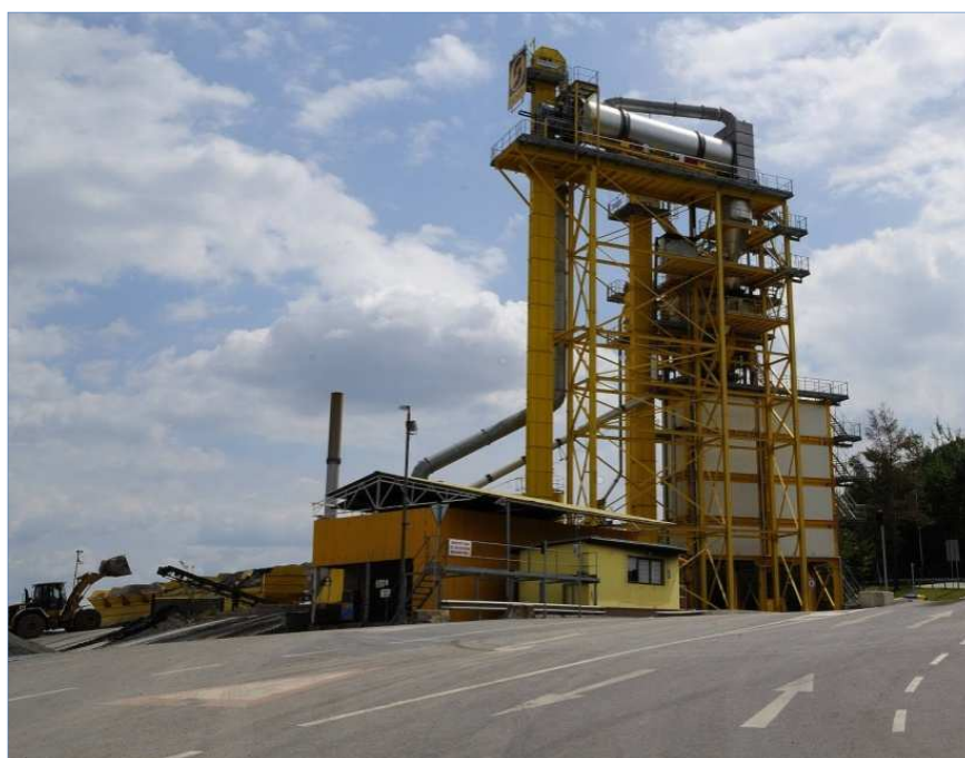
Obr. 5: Obalovna s paralelním bubnem [12]
