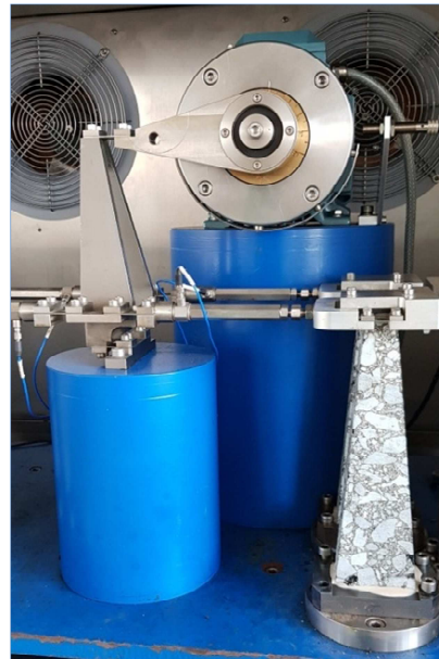
Obr. 24 a 25: Zkušební zařízení „Cooper“ pro zkoušku modulů tuhosti a únavy asfaltových směsí
