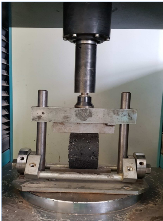
Obr. 22: Zkušební těleso v lisu při zkoušce ITSR
