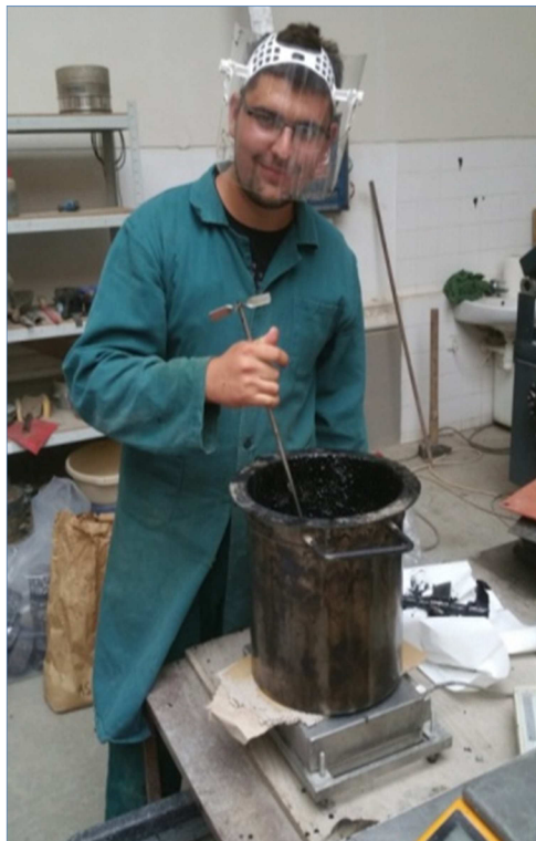
Obr. 12,13: Příprava modifikovaného asfaltového pojiva
