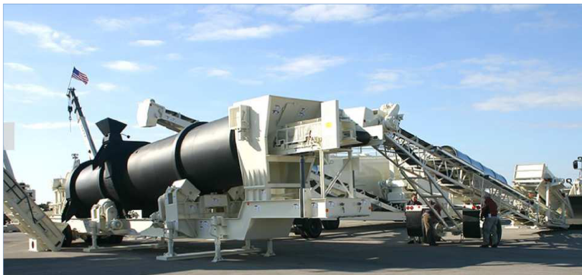
Obr. 10: Schéma kontinuální obalovny s tzv. Counter-Flow technologií [17]
