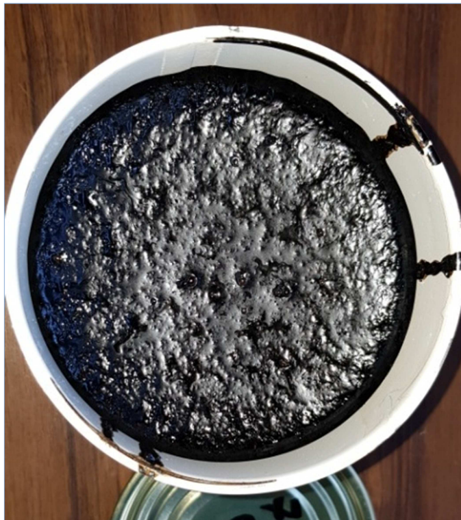
Obr. 12,13: Příprava modifikovaného asfaltového pojiva
