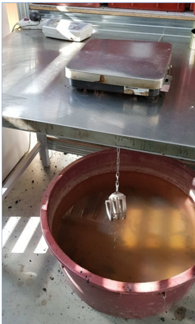
Obr. 17: Zařízení pro měření objemové hmotnosti
