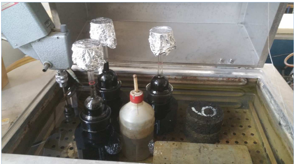
Obr. 19: Pyknometry v temperanční komoře
