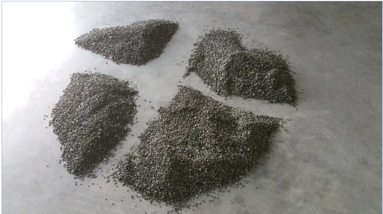
Obr. 16: Kvartace kameniva frakce 8/11
