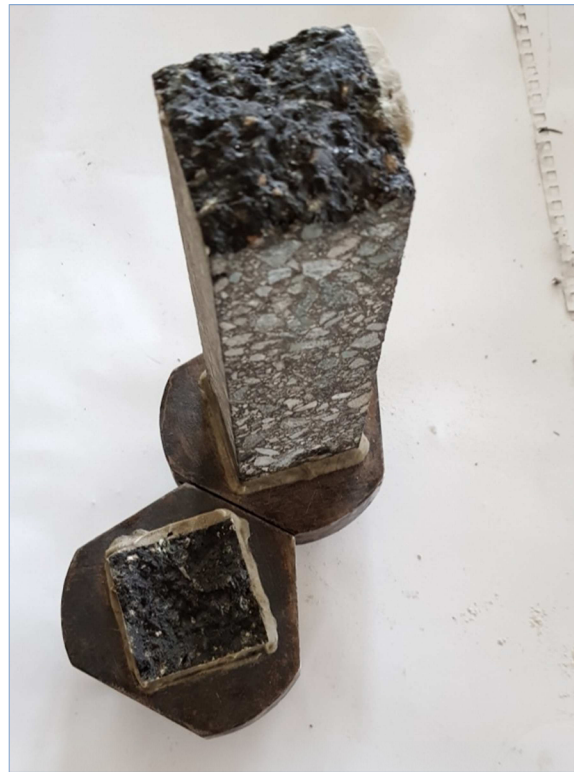
Obr. 27: Porušený vzorek ze zkoušky nízkoteplotních vlastností
