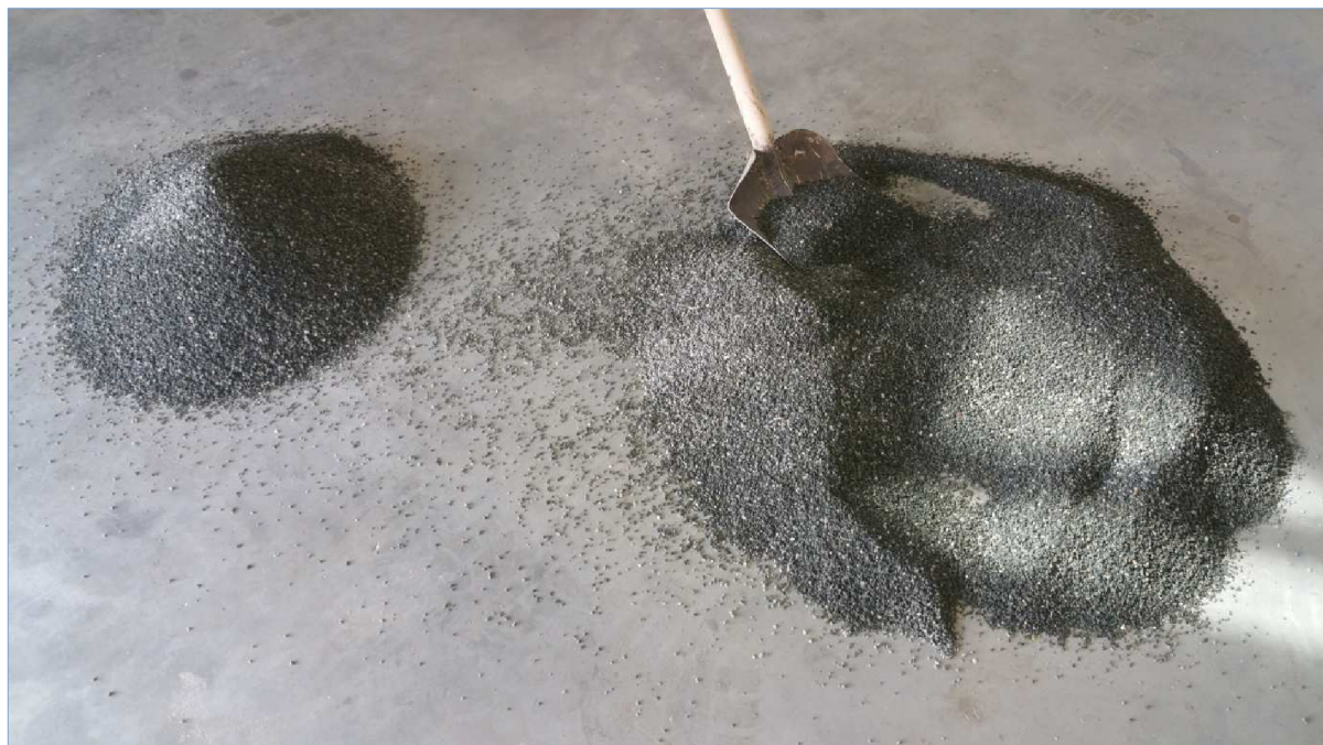
Obr. 15: Homogenizace kameniva frakce 4/8
