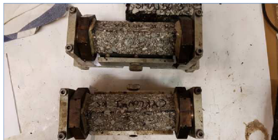
Obr. 38: Trámce na zkoušku nízkoteplotních vlastností
