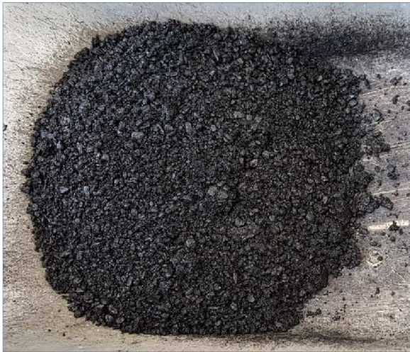
Obr. 32: Připravená směs na hutnění
