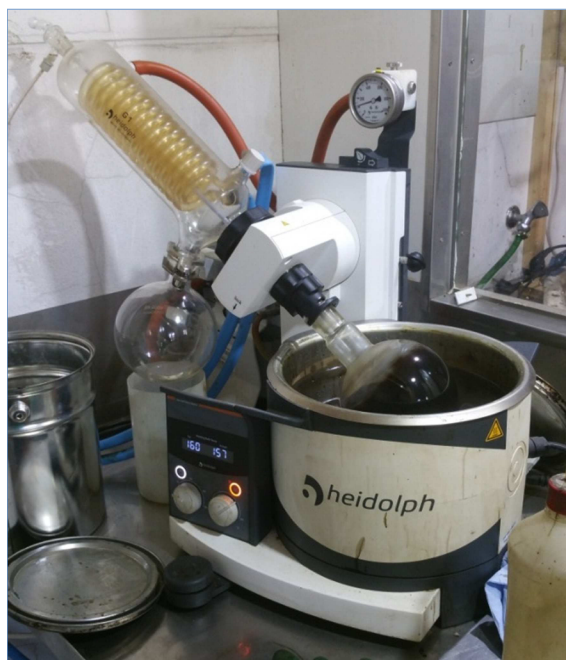
Obr. 14: Destilace asfaltu z R-materiálu
