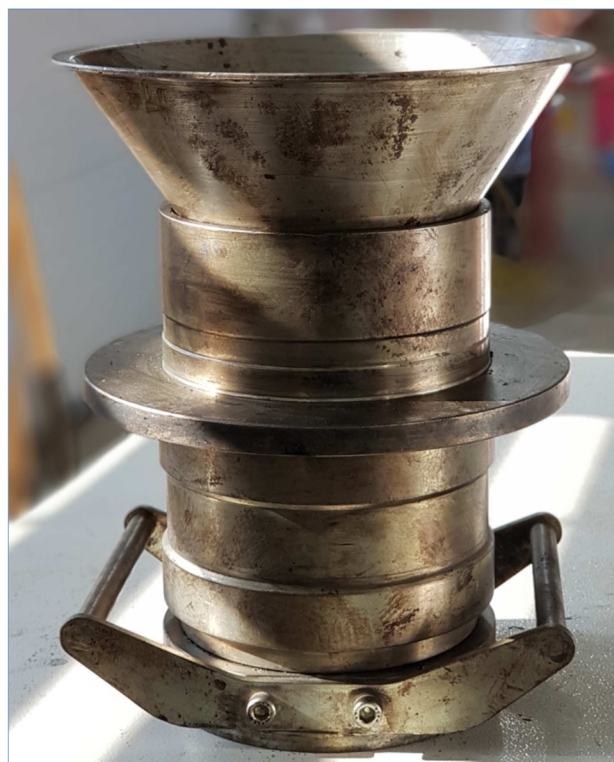
Obr. 30: Forma na výrobu Marshallových těles
