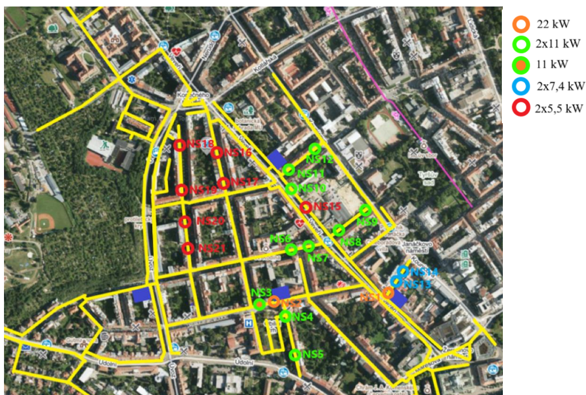
Obrázek 10.2 Schéma sítě VO + 37 NB v oblasti ulice Veverí
