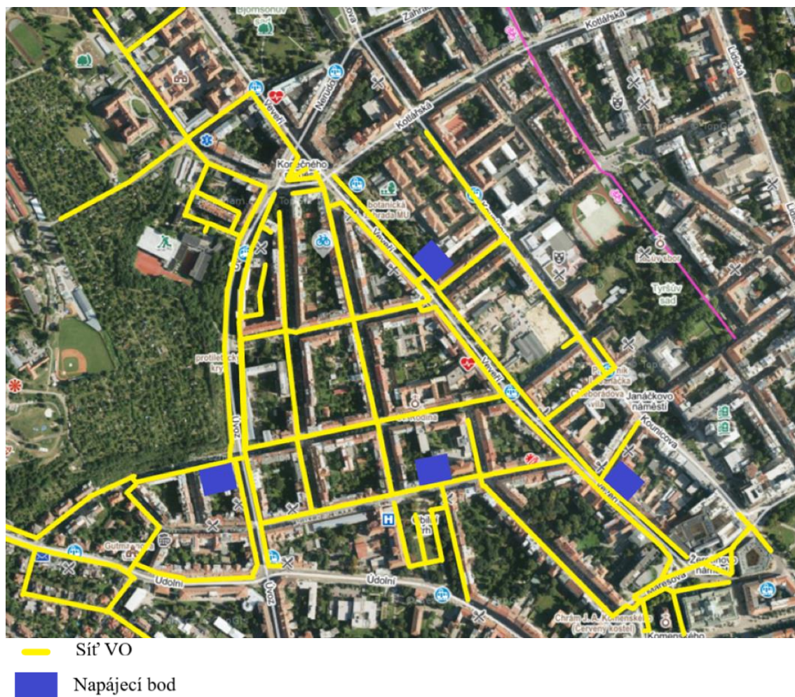
Obrázek 10.1 Schéma sítě VO v oblasti ulice Veverí
