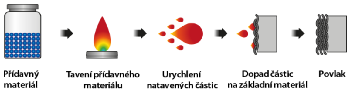
Obrázek 2: Technologický proces žárového stříkání [7]
