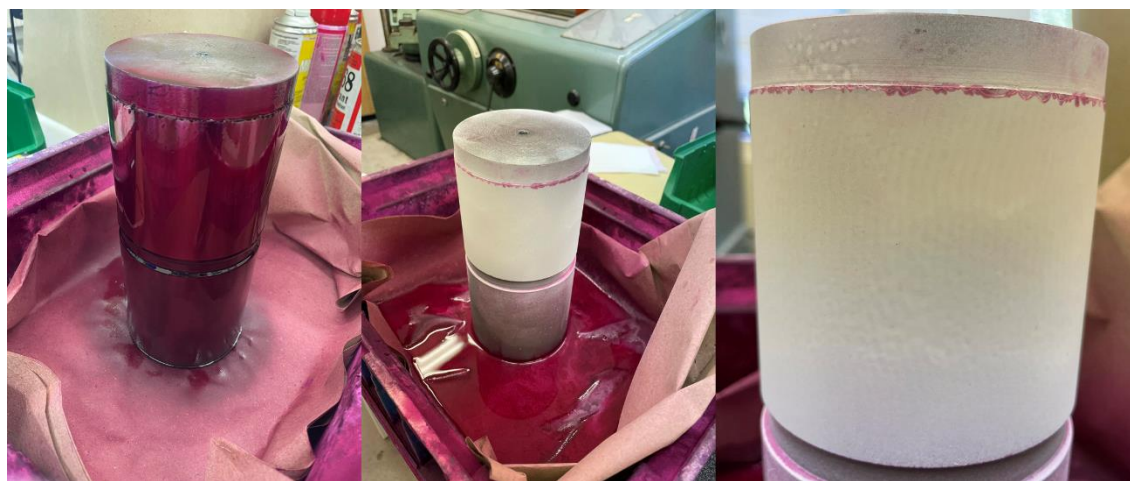
Obrázek 92: Postup provedení kapilární zkoušky s negativní detekcí mikro i makrotrhlin spojených s povrchem obrobku
