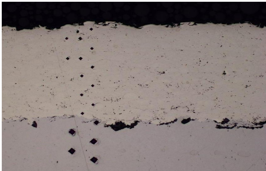
Obrázek 12: Defekty v přechodové oblasti nástřiku Stellite 6 [37]
