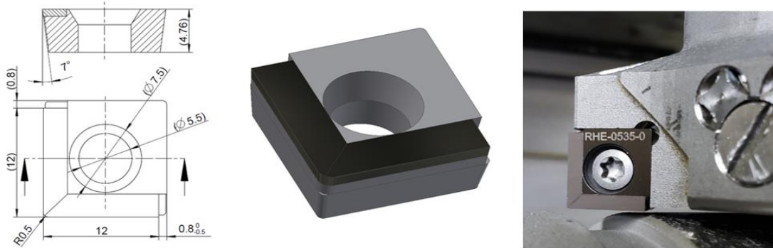
Obrázek 52: Rozměry břítové destiček SCMW 120405
