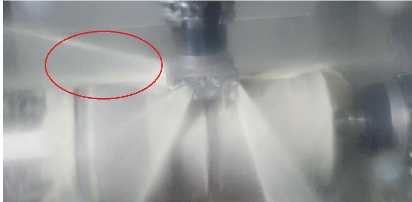
Obrázek 38: Rozptýlení kapaliny po výstupu z kanálku
