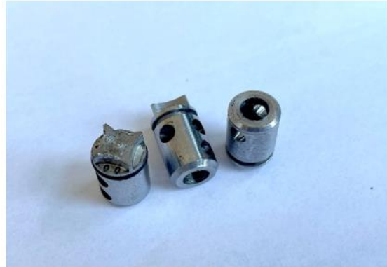
Obrázek 29: Návrh a reálná podoba regulačních členů nástroje
