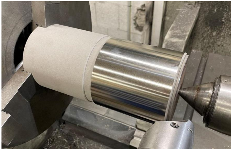
Obrázek 88: Vzhled obrobeneho povrchu po dokončování ve firmě Plasmametal
