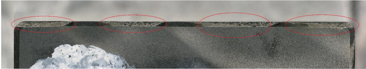
Obrázek 75: Snímek břitové destičky PCBN Bonar po obrobení ve čtyřech Y pozicích
