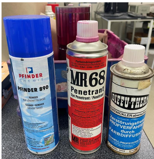
Obrázek 91: Sada použitá pro provedení kapilární zkoušky dle ČSN EN ISO 3452
