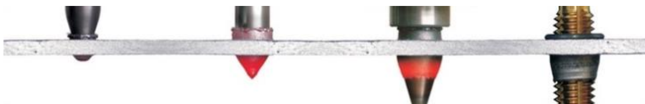
Obr. 20 Princip termálního vrtání [21]
