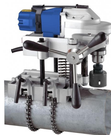
Obr. 11 Vrtačka s řetězovým Upnutím [13]
