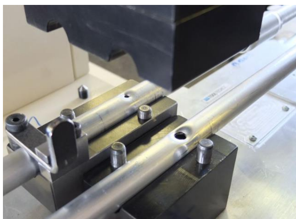
Obr. 34 Děrování s deformací [33]
