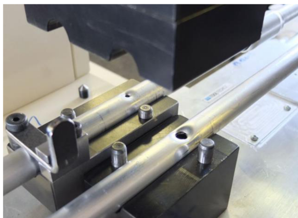
Obr. 34 Děrování s deformací [33]
