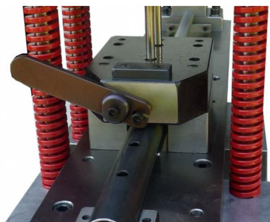
Obr. 36 Děrování bez deformace [34]
