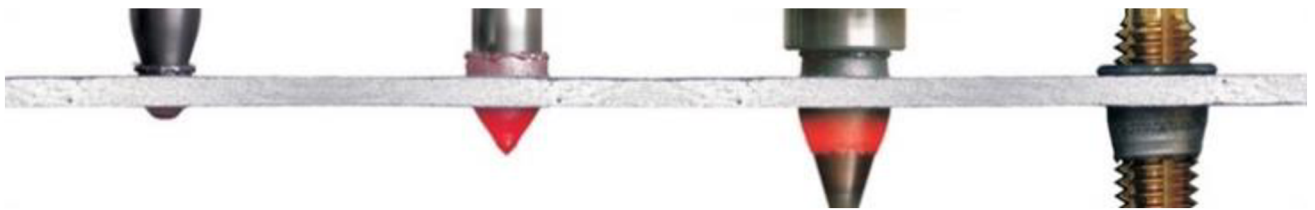
Obr. 20 Princip termálního vrtání [21]
