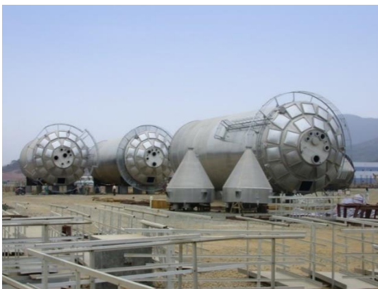
Obr. 24 Protiexplozní membrány na silu [19]
