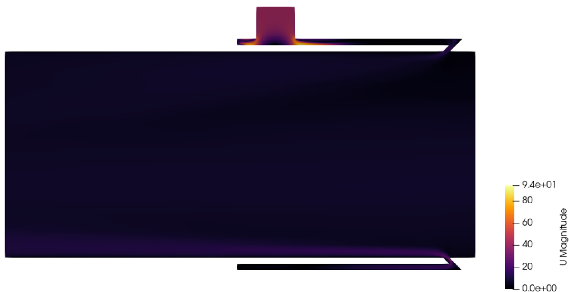
Obr. 41 Řez ejektorem zobrazující rychlost vzduchu v m/s
