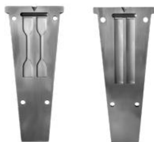
Obrázek 3.6 Vstřikovací forma (ISO 527) vlevo a (ISO 179-1) vpravo [48]
