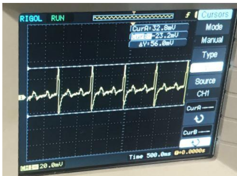
Obr. 31 Průběh stimulace na osciloskopu se zátěží (Zdroj: autor)
