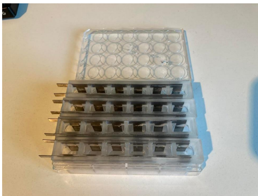
Obr. 23 Usazení zařízení do titrační destičky (Zdroj: autor)
