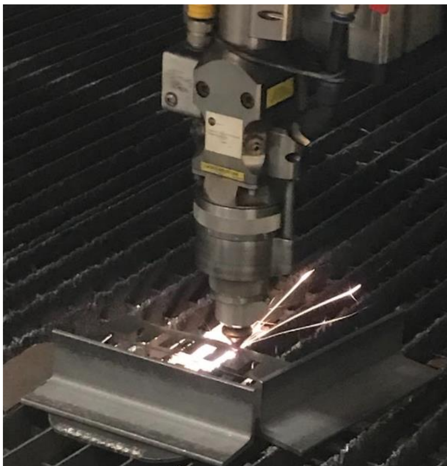
Obr. 3 Proces řezání vláknovým laserem (Zdroj: autor)
