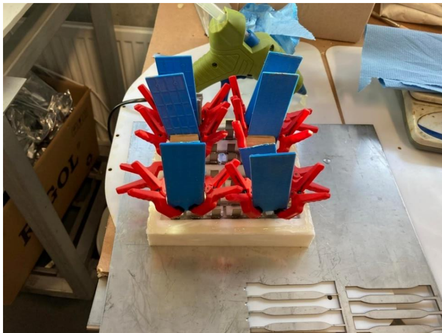
Obr. 18 Titanové elektrody vsazené do tekuté pryskyřice v silikonové formě (Zdroj: autor)
