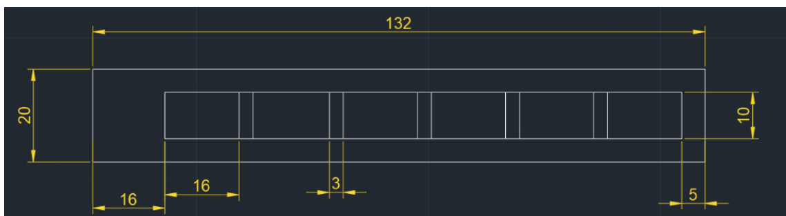
Obr. 7 Návrh zařízení pro finální tvar formy (Zdroj: autor)
