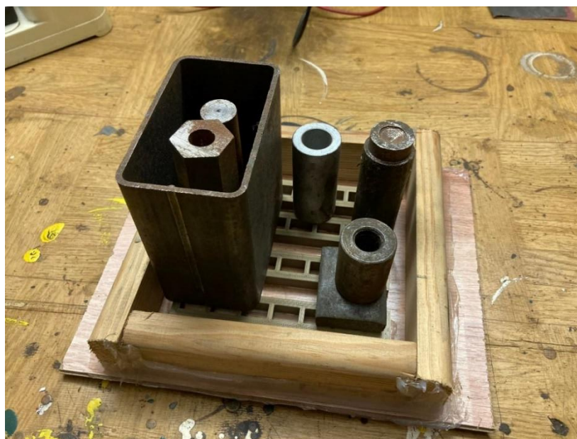
Obr. 11 Přilepená a zatěžkaná zařízení v dřevěné formě (Zdroj: autor)
