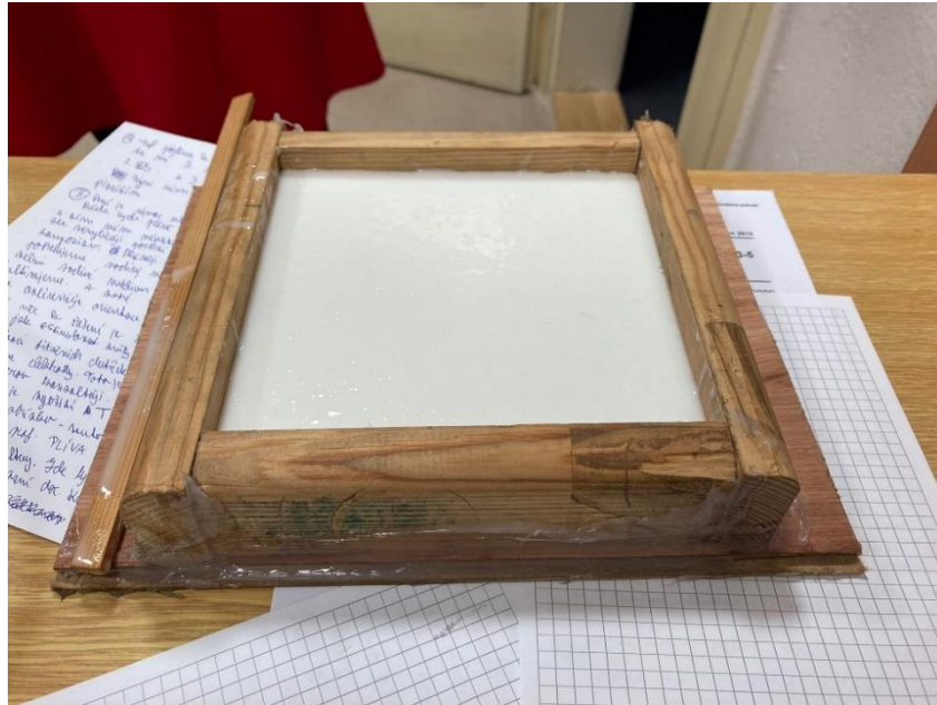
Obr. 14 Tuhnutí silikonu v dřevěné formě (Zdroj: autor)
