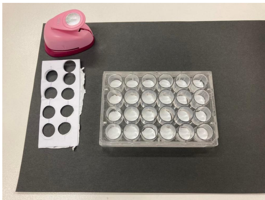
Obr. 27 Vykrajovaný materiál usazený do titrační destičky (Zdroj: autor)
