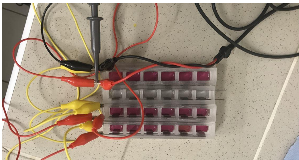
Obr. 29 Testování vyrobeného zařízení elektrickou stimulací (Zdroj: autor)
