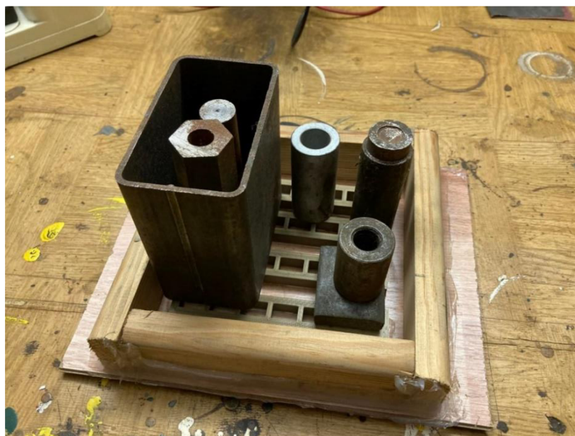
Obr. 11 Přilepená a zatěžkaná zařízení v dřevěné formě (Zdroj: autor)
