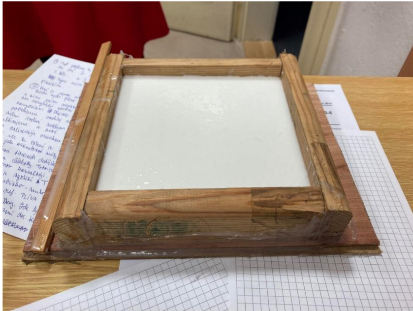
Obr. 14 Tuhnutí silikonu v dřevěné formě (Zdroj: autor)
