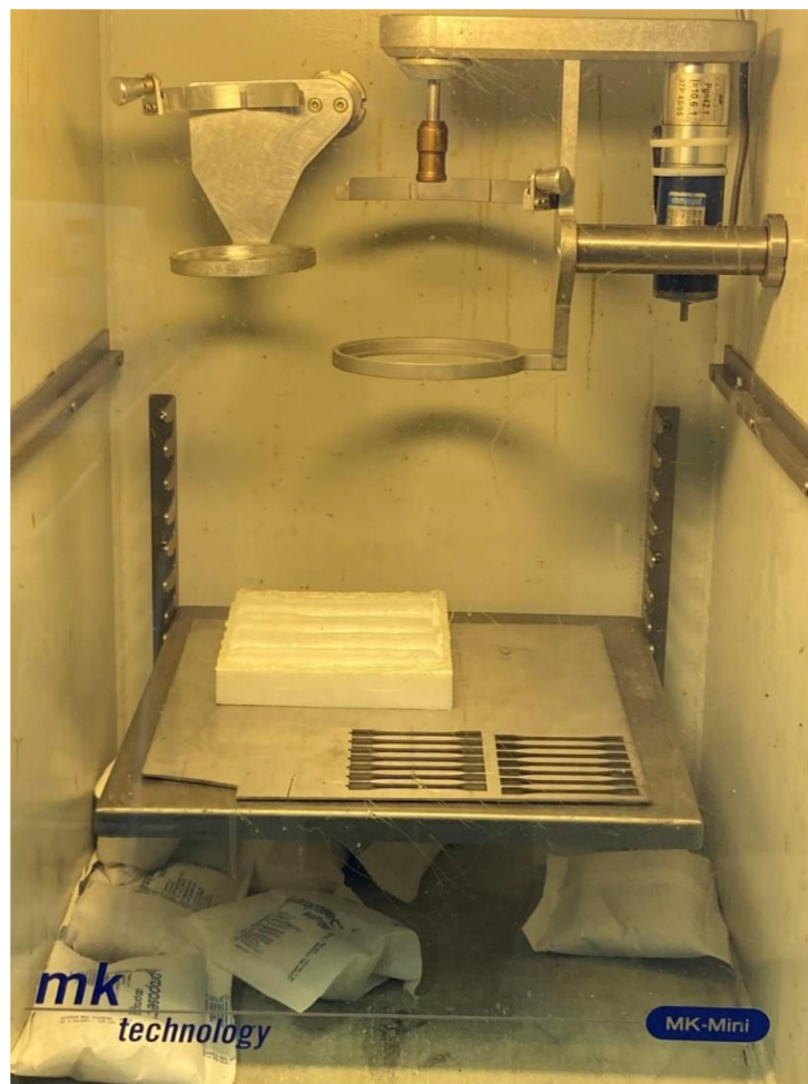
Obr. 16 Silikonová forma s epoxidem ve vakuové komoře (Zdroj: autor)
