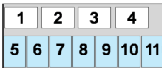
Obr. 4.15 Grafické vyobrazení nakládky EURO palet v kontejneru ISO 1C
