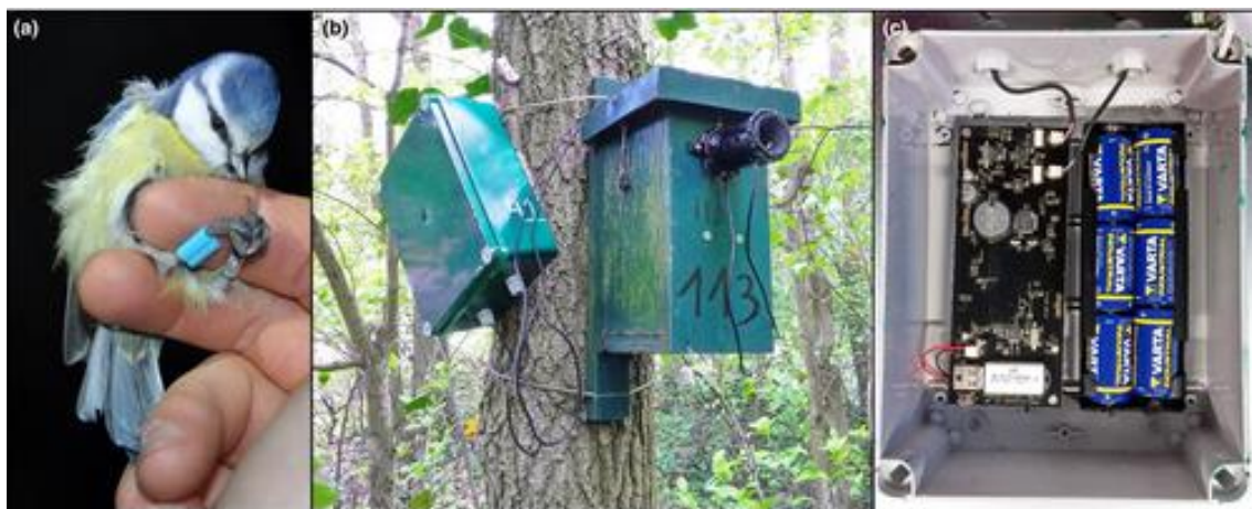
Obrázek 2: (a) transpondér v kroužku sýkory modřinky ( Cyanistes caeruleus ); (b) čtecí zařízení (vlevo) a anténa; (c) vnitřní část čtecího zařízení. Foto: Iserbyt A.
