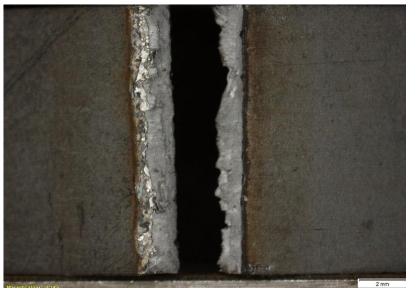
Obr. 48 Křehký lom zkušební vzorku č. 1 v oblasti svarového kovu.
