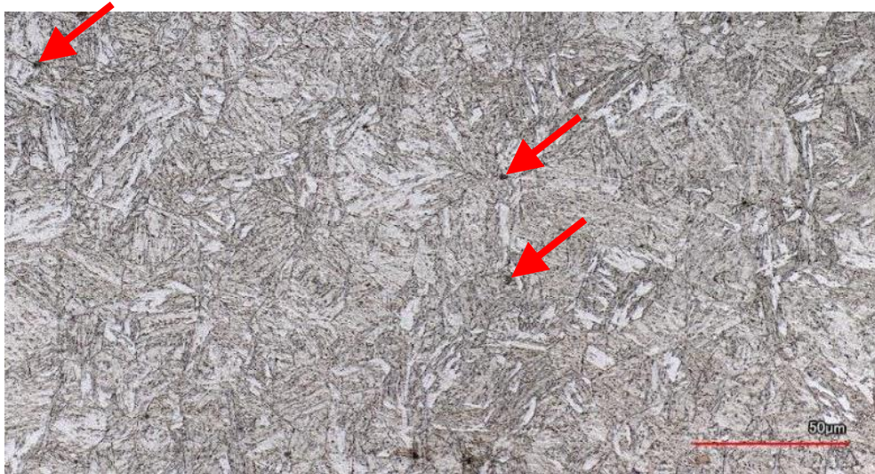
Obr. 62 vzorek č. 4 svařování dle tab. 12 - vyžihaná oblast v TOO.
