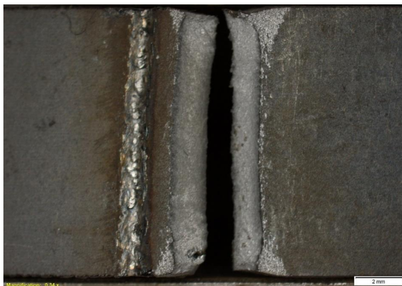
Obr. 49 Křehký lom zkušební vzorku č. 2 v TOO.
