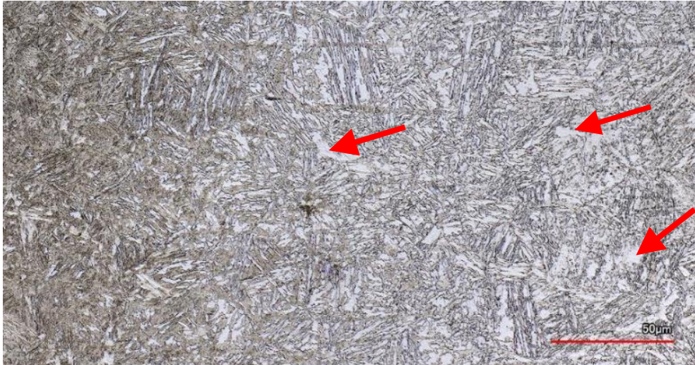
Obr. 61 vzorek č. 3 svařování dle tab. 12 - oblast částečné překrystalizace v TOO – viditelná precipitace nové fáze.
