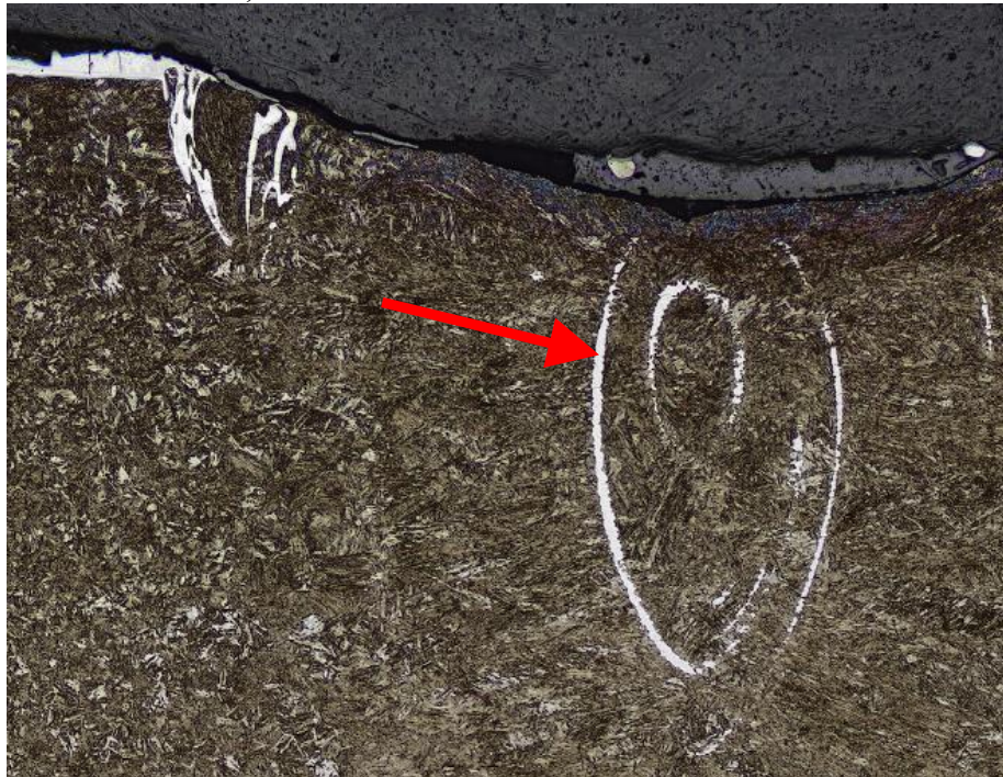
Obr. 57 vzorek č. 1 svařování dle tab. 12 – oblast SK 10x zvětšeno – bílé útvary podobné povlaku.
