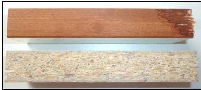
Obr. 60 - Detail vzorků EVA (dole) a PUR lepidla (nahore) při 70 °C (vlastní foto)
