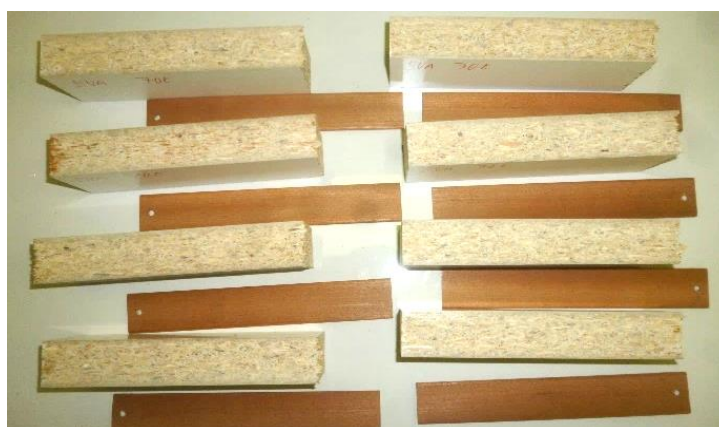
Ukázka vybraných vzorků ze zkoušky odlupování u lepidla EVA při teplotě 70 °C
