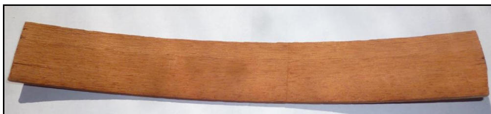
Obr. 77 - Dýhová hrana po ohybové zkoušce (vlastní foto)
