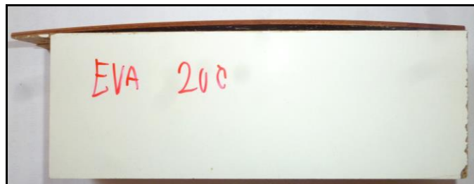
Obr. 61 - Odlepení dýhové hrany po vytažení z klimatizační komory (vlastní foto)
