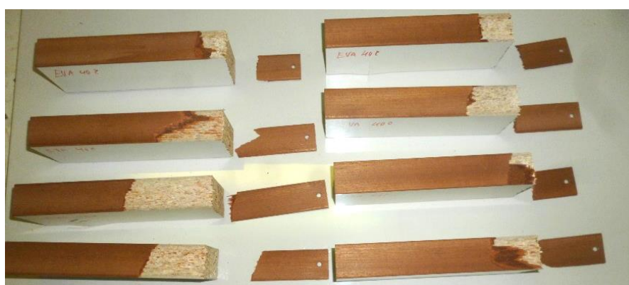
Ukázka vybraných vzorků ze zkoušky odlupování u lepidla EVA při teplotě 40 °C
