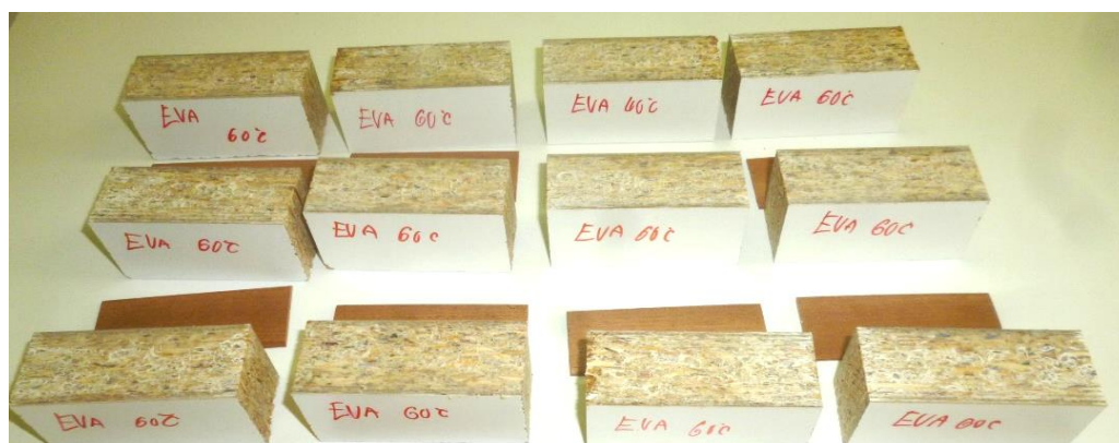
Ukázka vybraných vzorků ze zkoušky šikmého tlak. smyku u lepidla EVA při teplotě 60 °C
