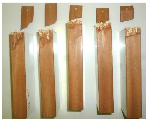
Ukázka vybraných vzorků ze zkoušky odlupování u lepidla PUR při teplotě 70 °C
