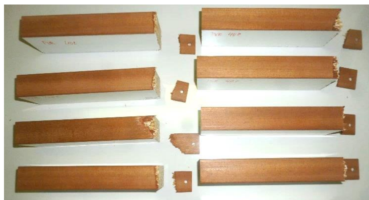
Ukázka vybraných vzorků ze zkoušky odlupování u lepidla PUR při teplotě 40 °C
