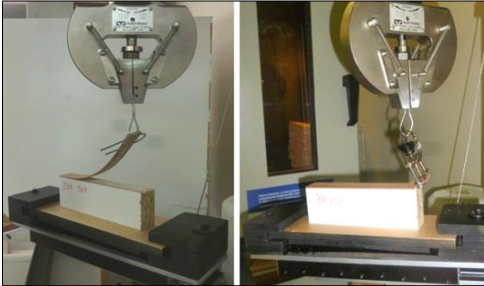
Obr. 59 - Ukázka rozdílného chování vzorků u EVA (vlevo) a PUR lepidla (vpravo) (vlastní foto)
