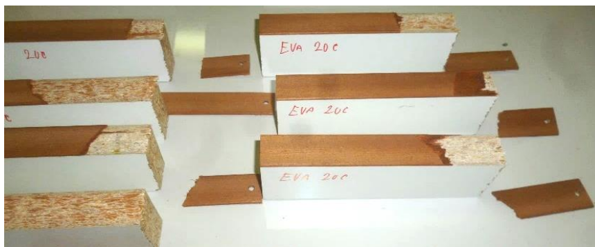
Ukázka vybraných vzorků ze zkoušky odlupování u lepidla EVA při teplotě 20 °C
