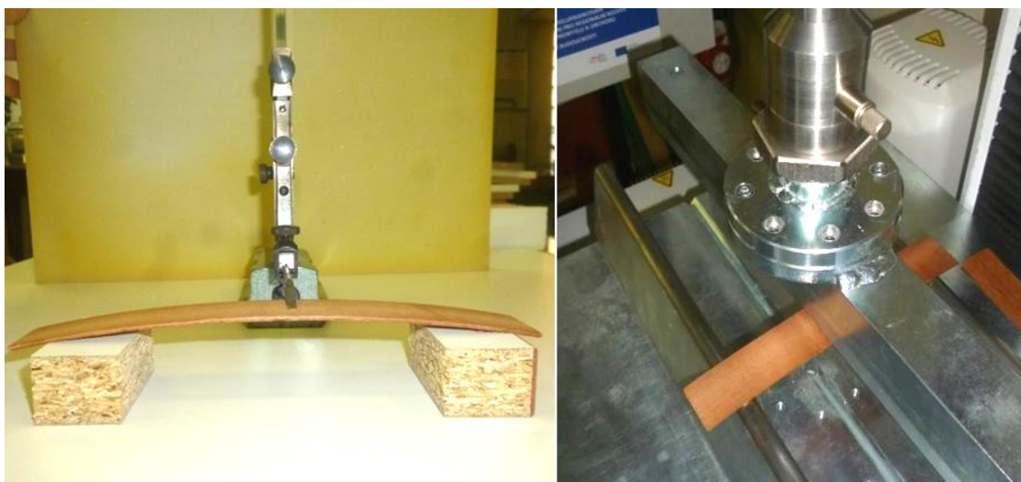
Ukázka dýhové hrany během ohybové zkoušky
