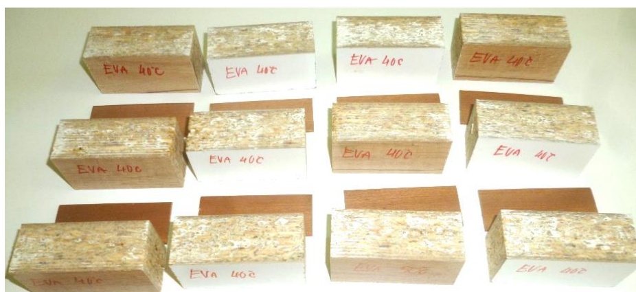
Ukázka vybraných vzorků ze zkoušky šikmého tlak. smyku u lepidla EVA při teplotě 40 °C
