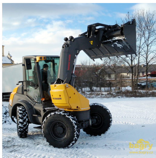
Obr. 28: Nakladač značky AHLMANN s otočným výložníkem [25]
