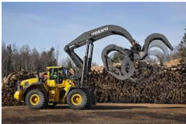
Obr. 42: Drapák specializovaného Volvo L180H HL nakladače [21]
