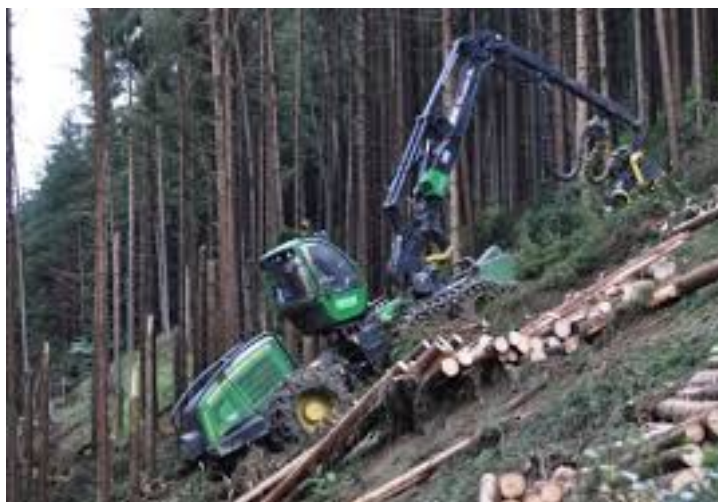
Obr. 3: Harvester firmy John Deere v extrémních svahových podmínkách [4]
