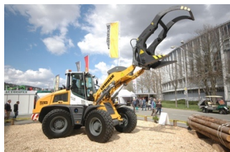
Obr. 24: Podvozek třetího typu – nakladač značky Liebherr [20]
