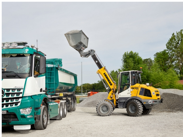
Obr. 27: Nakladač značky Liebherr s teleskopickým výložníkem [20]
