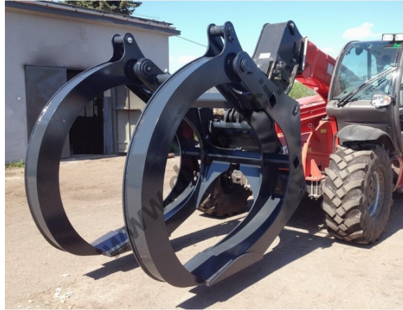
Obr. 36: Drápák pro manipulaci s velkým [15]
