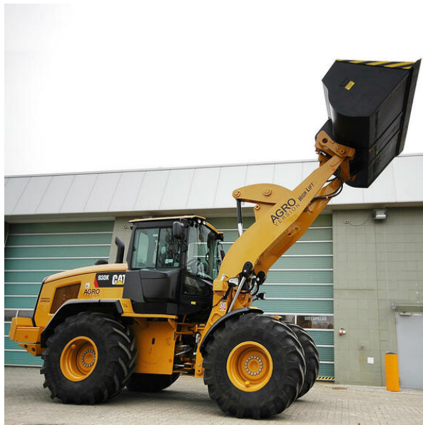
Obr. 26: Nakladač značky CAT s čelním výložníkem [22]
