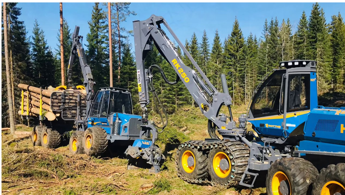
Obr. 11: Ukázka sledu prací harvestoru a vyvážecího traktoru [3]
