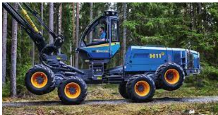
Obr. 6: ukázka boogie náprav schopných kopírovat terén [3]
