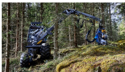
Obr. 5: Harvester Rottne H8D, princip příčné nivelace [3]
