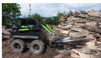
Obr. 25: Podvozek čtvrtého typu – smykový nakladač značky KOVACO [13]
