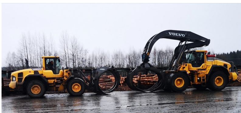
Obr. 29: Srovnání běžného a specializovaného nakladače značky Volvo [21]
