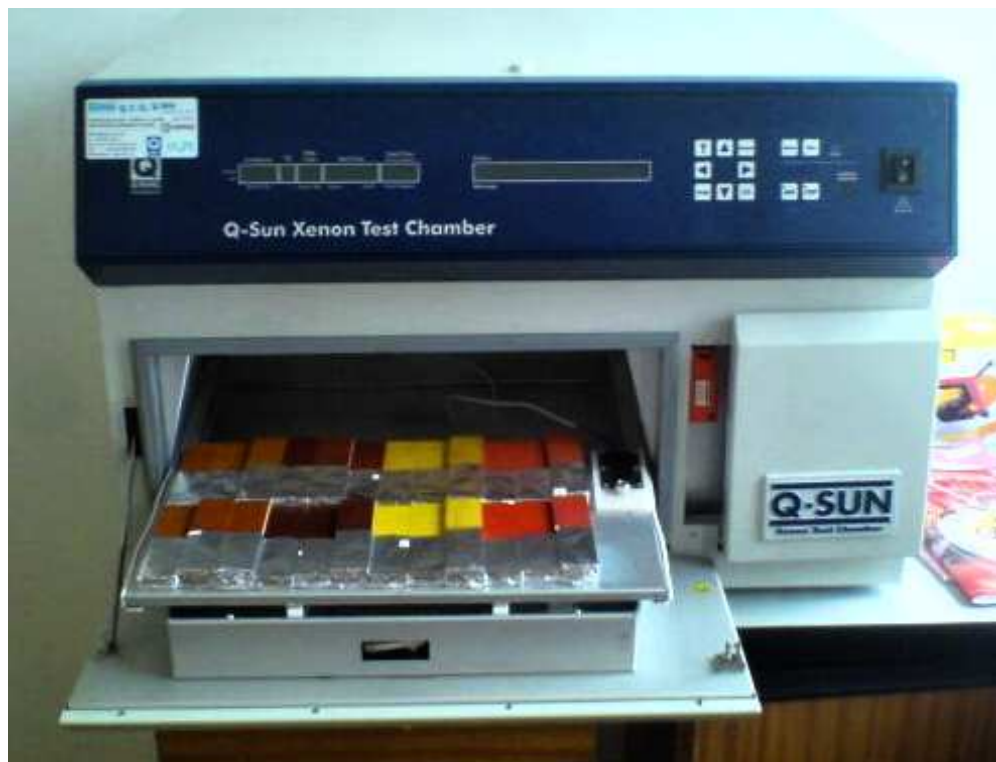
Obrázek 15 - Xenonová testovací komora Q-SUN Xe-1
