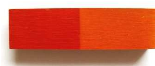
Obrázek 40 - Degradace PÚ, stupeň č. 1
