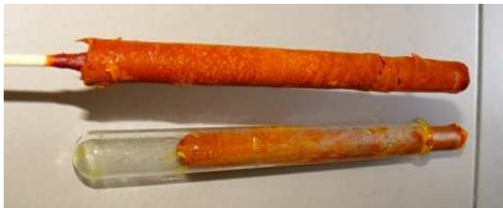
Obrázek 29 - Vytvrdlé lepidlo při zkoušce reaktivity
