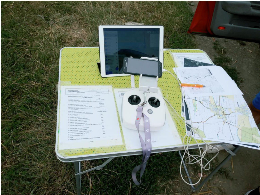
Obrázek č. 17: DJI Phantom 4 Pro - ovládací stanice.
