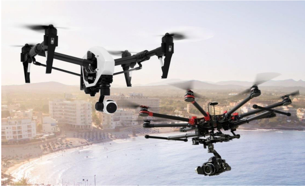
Obrázek č. 7: Kvadrokoptéra a oktakoptéra.
