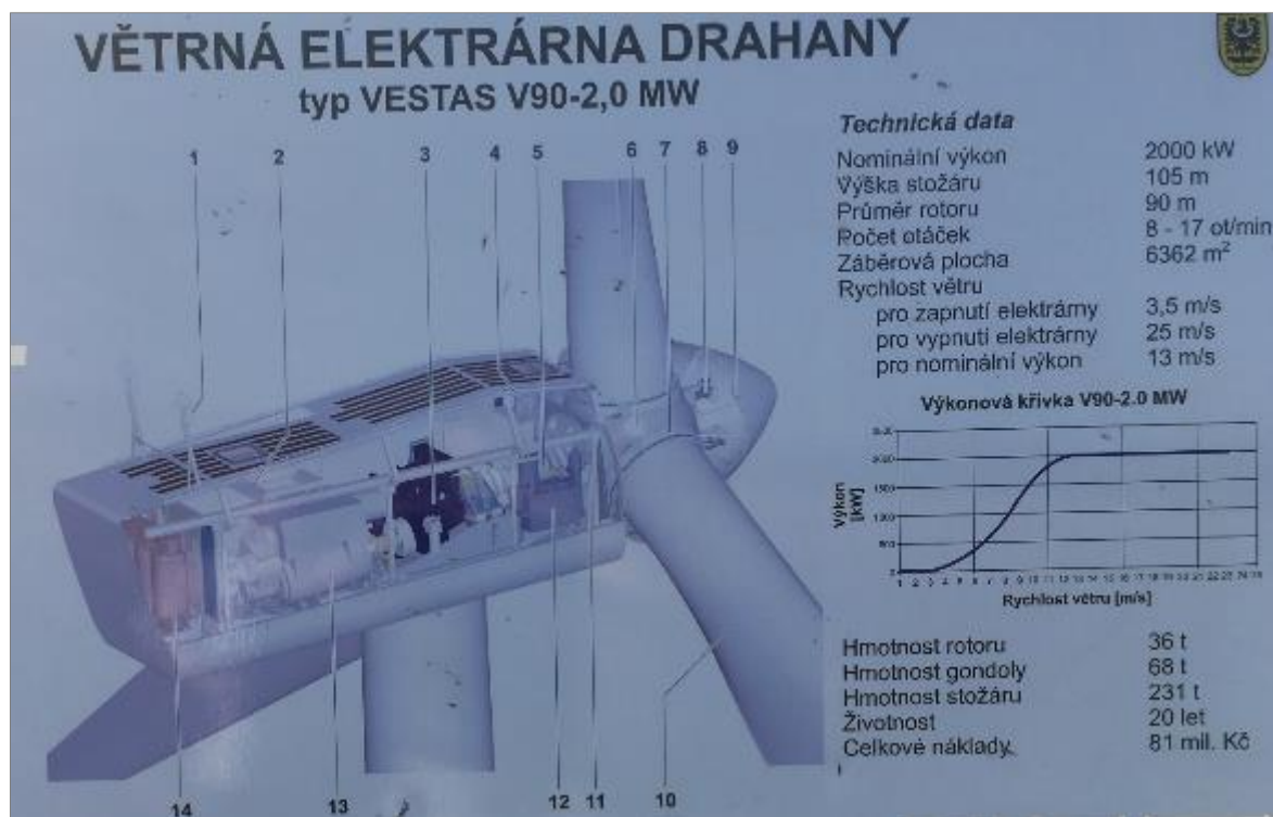
obr. 42: Stavba větrné elektrárny (Maryška, M. 2019)
