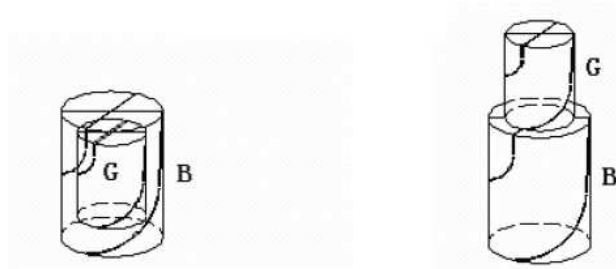
Obr. 4.6: Spojení dvou quadrifilárních šroubovicových antén [6]
