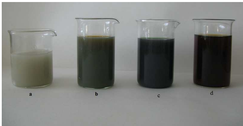
Obr. 8 : Disperze koloidního Ag připravené redukcí a – hydroxylaminem, b – citranem sodným c – hydrazinem, d – maltózou.
