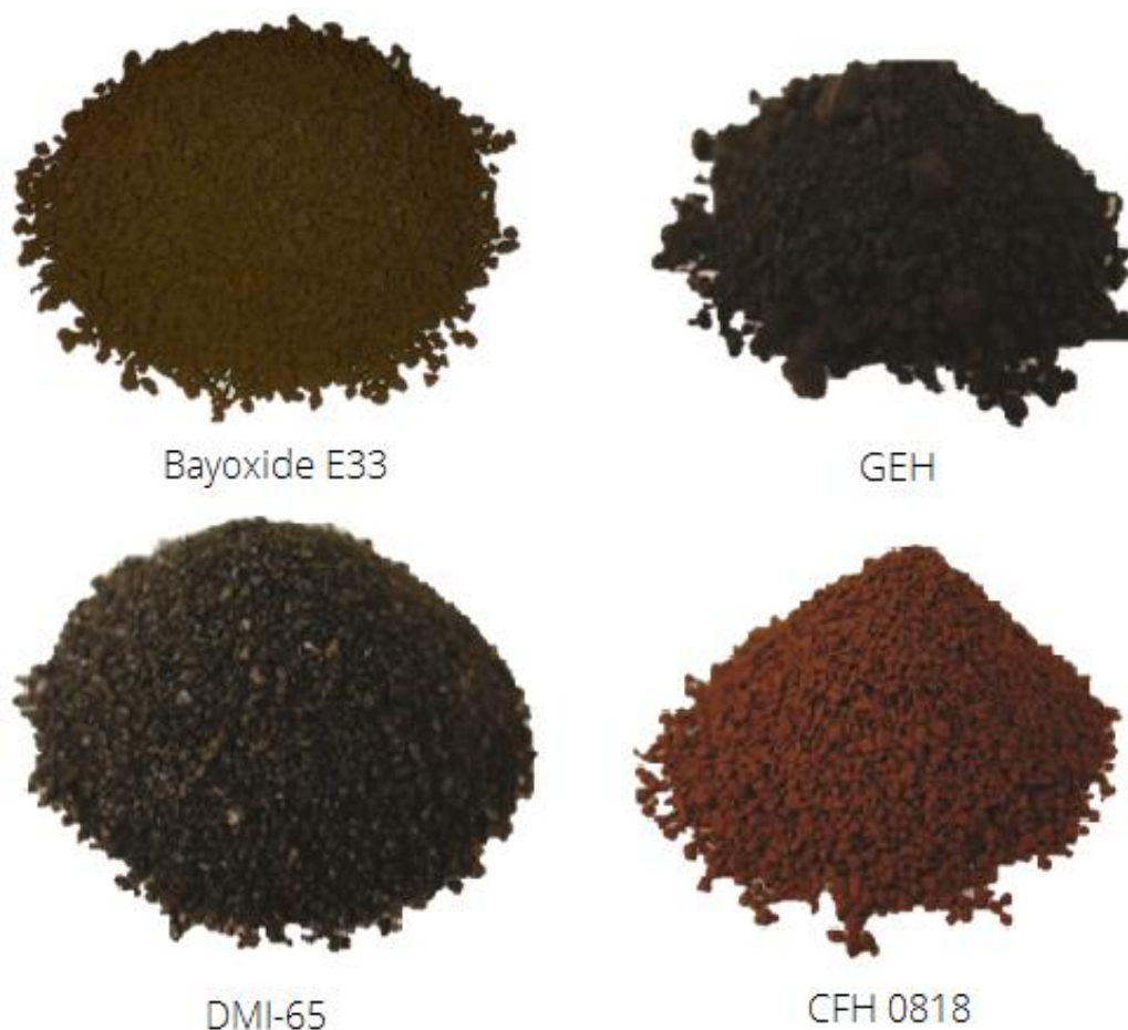
Obr. 11 Vybrané sorpční materiály pro odstraňování kovů z vody [autor]
