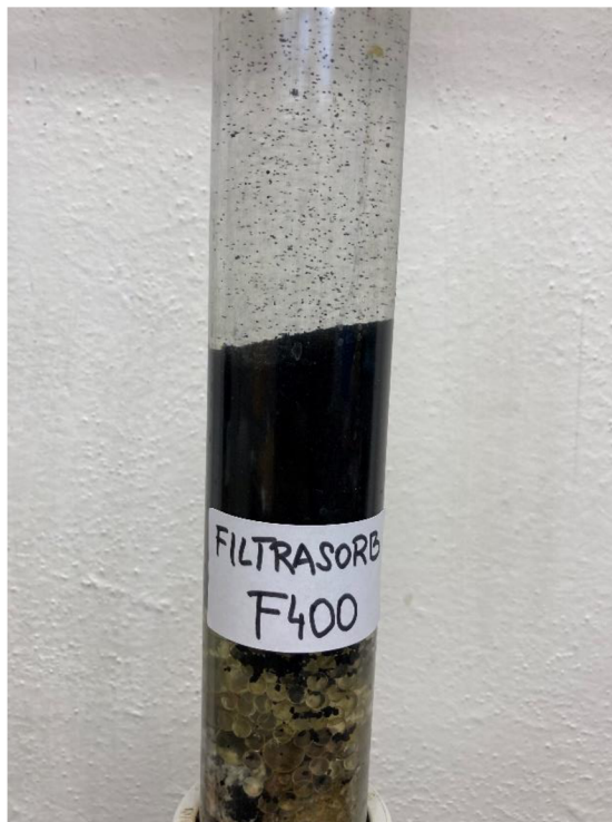
Obr. 45 Praní sorbentu Filtrasorb F400 [autor]
