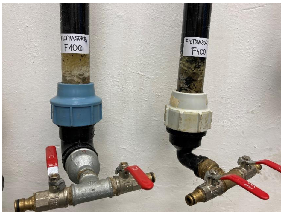
Obr. 47 Odběrné uzávěry kolon s přichystanými adsorbenty [autor]
