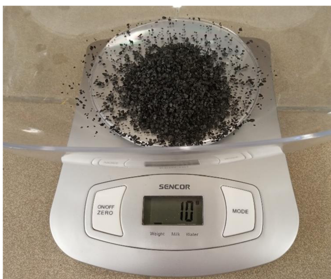
Obr. 40 Přesné odvážení adsorbentu [autor]
