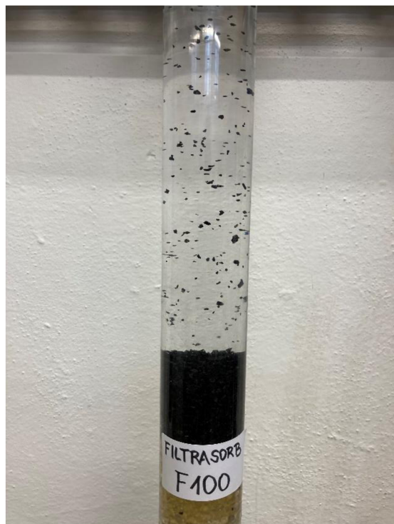
Obr. 46 Praní sorbentu Filtrasorb F100 [autor]
