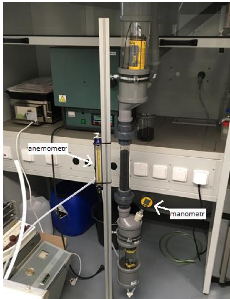
Obr. 3.5 Detail kolony, umístění detektorů, manometru a anemometru s možností redukce průtoku vzduchu
