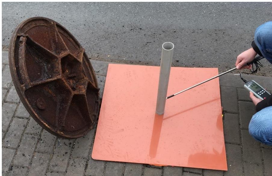
Obr. 4.19 Měření rychlosti proudění vzduchu
