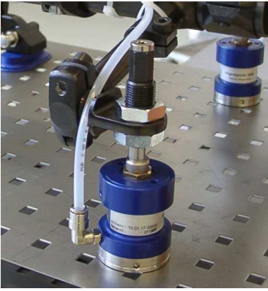
Obr. 6-1.: Uchopení pomocí magnetické síly [79]
