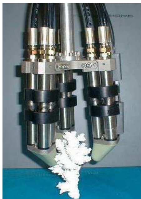
Obr. 5-6.: Uchopovací hlavice s pneumatickým pohonem [32] - vlevo
