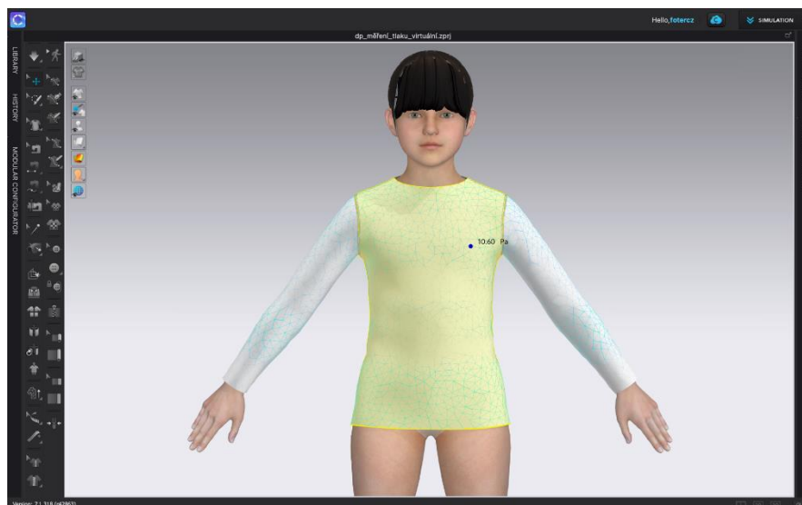
Obr. 45 Ověření padnutí oděvu na virtuální postavě.
