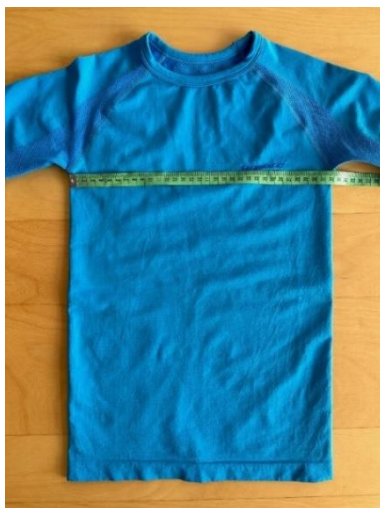
Obr. 22 Příklad měření rozměru 1/2 šíře hrudníku na výrobku.
