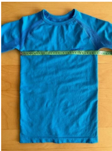
Obr. 22 Příklad měření rozměru 1/2 šíře hrudníku na výrobku.
