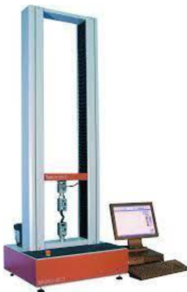
Obr. 26 Trhací přístroj Testometric M350-5CT. [10]
