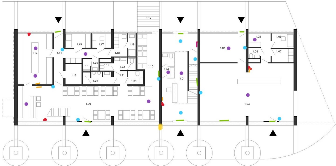
Obrázek 16 - Návrh požárního zabezpečení 1NP [vlastní]
