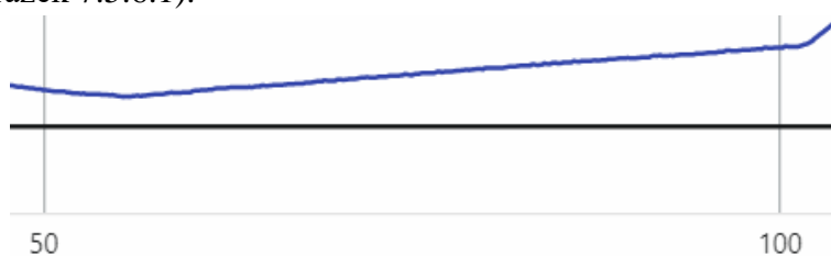
Obrázek 7.5.6.1: Pozvolný růst tlaku mezi 50. a 100. sekundou při zavřeném ventilu.
