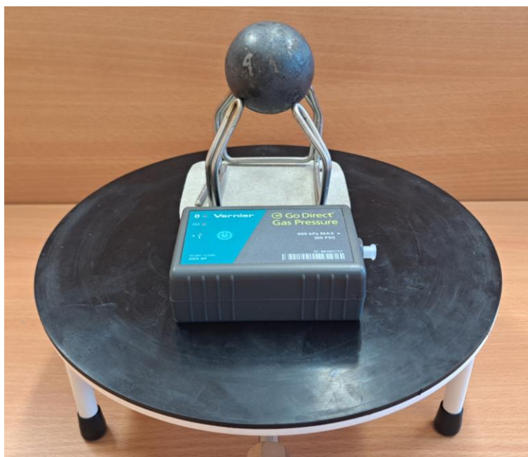
Obrázek 7.6.4.1: Umístění senzoru tlaku, koule s držákem a kamennou podložkou na talíři.
