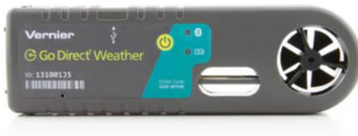
Obrázek 7.4.2.1: Senzor počasí GDX-WTHR bez korouhvičky. [34]
