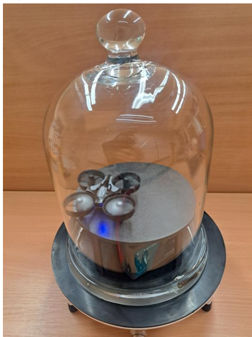
Obrázek 7.5.5.2: Dron se za nízkého tlaku nevznese.
