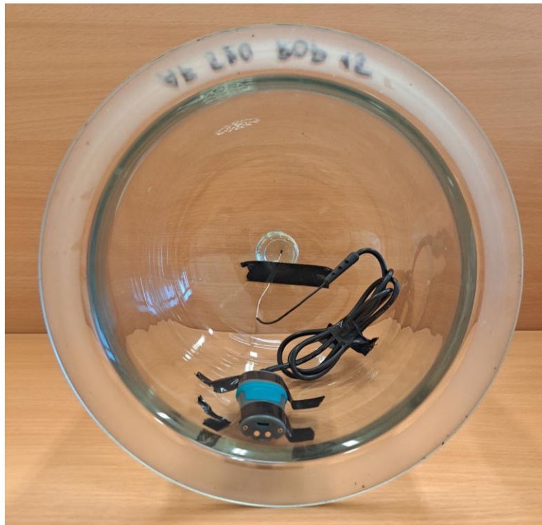
Obrázek 7.6.4.2: Připevnění čidla teploty pod vrchol recipientu pomocí lepenky.
