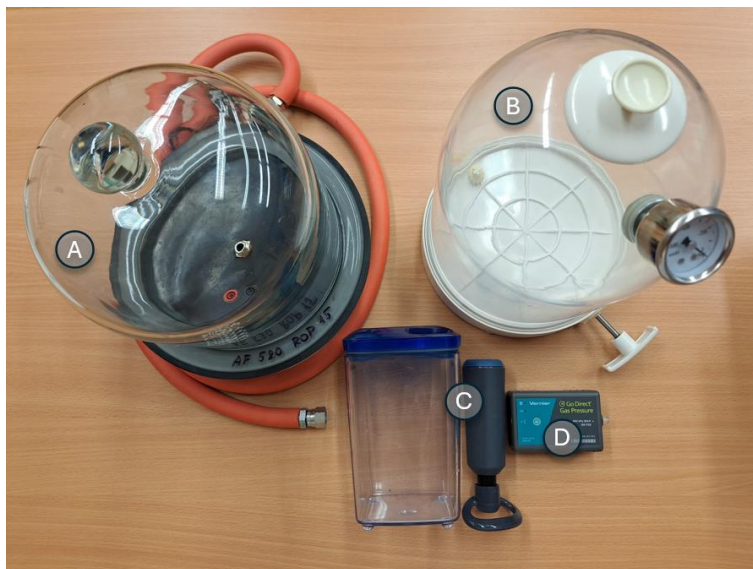
Obrázek 7.2.3.1 : Pomůcky k měření různých druhů vakua
