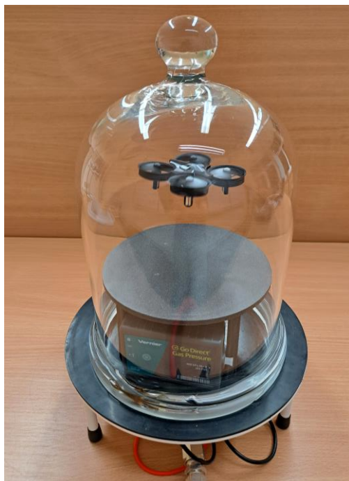
Obrázek 7.5.5.1: Let dronu pod recipientem za atmosférického tlaku.
