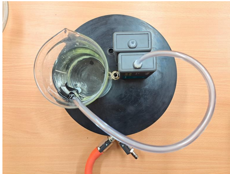
Obrázek 7.3.4.1: Rozložení pomůcek na talíři vývěvy.
