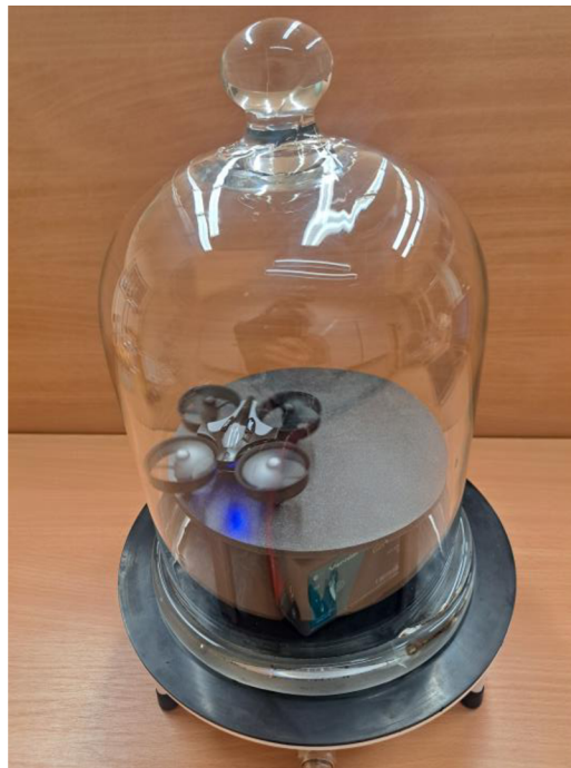
Obrázek 7.5.5.2: Dron se za nízkého tlaku nevznese.
