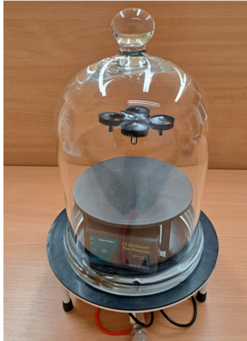
Obrázek 7.5.5.1: Let dronu pod recipientem za atmosférického tlaku.
