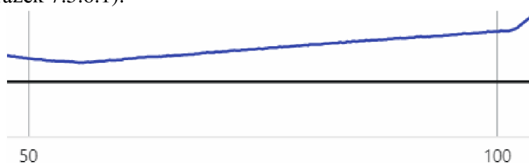
Obrázek 7.5.6.1: Pozvolný růst tlaku mezi 50. a 100. sekundou při zavřeném ventilu.
