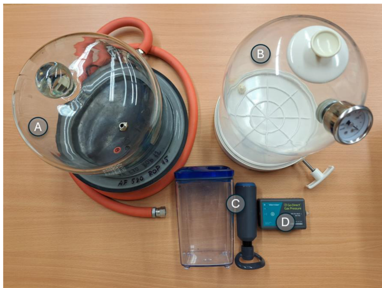
Obrázek 7.2.3.1 : Pomůcky k měření různých druhů vakua
