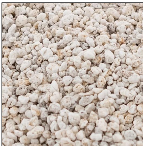
Obr. č. 16 – Expandovaný perlit [37]
