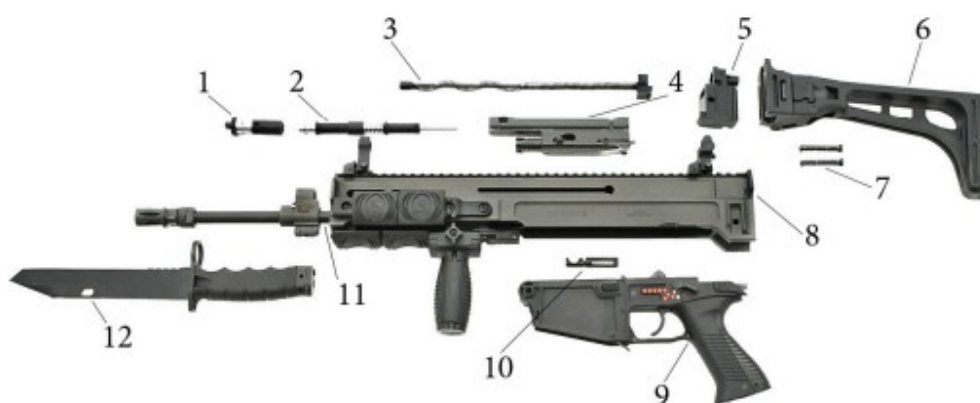
Obrázek 2 Hlavní části útočné pušky BREN CZ 805 A1
